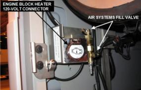
ENGINE BLOCK HEATER 120 VOLTS CONNECTOR
