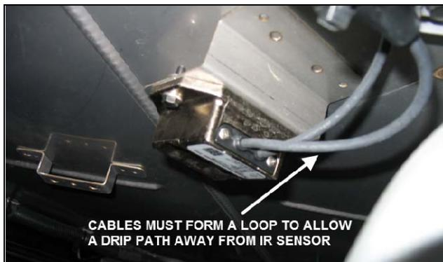
FIGURE 33 : LES FILS DOIVENT FORMER UNE COURBE VERS LE BAS
