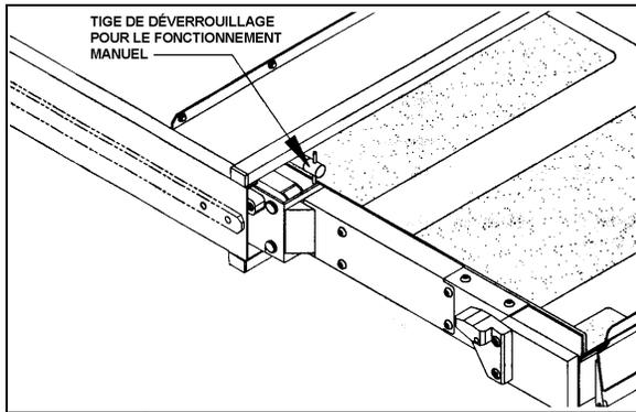
TIGES DE DÉVERROUILLAGE DE LA PLATE-FORME
