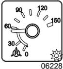
06226   | Oui                | Pression d'air du système d'air primaire est inférieure à 66 psi (860 kPa)                       |
