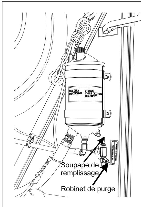
**SOUPAPE DE REMPLISSAGE DU COMPARTIMENT MOTEUR**
