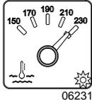
06231 | Oui                | Température du liquide de refroidissement est supérieure à 223°F (106°C)                         |
