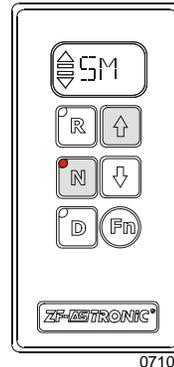
Il y a une **anomalie grave dans le système** lorsque le témoin lumineux dans le tableau de bord s'allume et que l'afficheur du sélecteur de vitesse indique «SM».
