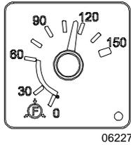
Cet instrument indique la pression d'air du système secondaire. La pression normale de fonctionnement se situe entre 655 et 860 kPa (95 et 125 psi).
