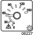
06227   | Oui                | Pression d'air du système d'air secondaire est inférieure à 66 psi (860 kPa)                     |
