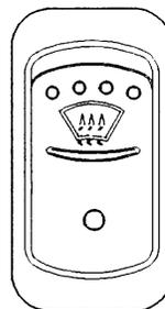
L'autocar peut être équipé d'un système de dégivrage de la partie supérieure des pare-brise. Basculer l'interrupteur vers le bas pour mettre en marche la pompe de recirculation et le ventilateur qui permet de pousser l'air réchauffé afin de désembuer, dégivrer et déglacer la partie supérieure des pare-brise.
