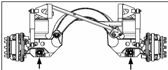
POINTS DE LEVAGE SOUS L'ESSIEU AUXILIAIRE 11029
