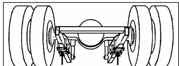
POINTS DE LEVAGE SOUS L'ESSIEU MOTEUR
