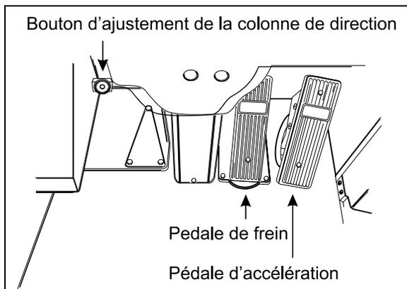
INCLINAISON ET RÉGLAGE TÉLESCOPIQUE 18436
