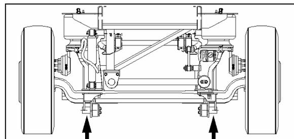
POINTS DE LEVAGE SOUS L'ESSIEU AVANT - ESSIEU
