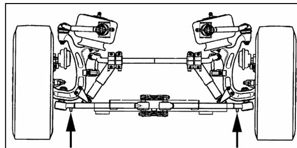
POINTS DE LEVAGE SOUS L'ESSIEU AVANT -
