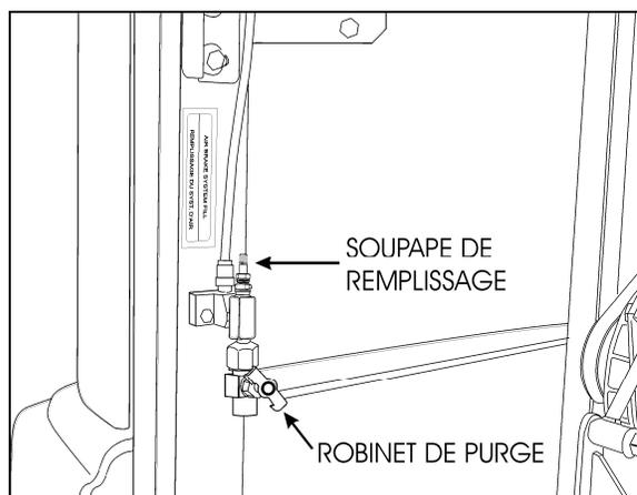
SOUPAPE DE REMPLISSAGE DU COMPARTIMENT MOTEUR 12219
