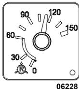
Cet instrument indique la pression d'air du système primaire. La pression normale de fonctionnement se situe entre 655 et 860 kPa (95 et 125 psi).
