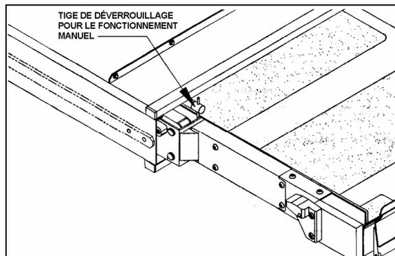
TIGES DE DÉVERROUILLAGE DE LA PLATE-FORME
