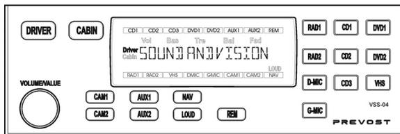
L'unité de commande audiovisuelle VSS-04 permet au conducteur de sélectionner la musique d'ambiance ou la vidéo de divertissement et de contrôler de façon indépendante les réglages audio (volume, niveau des basses, des aigus, etc.) dans la section des passagers et la section du conducteur. Cette unité permet également de contrôler la radio, le lecteur DVD, le lecteur de vidéo cassette, le système de diffusion publique, les systèmes auxiliaires ou autres.
