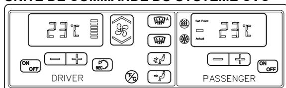
L'intérieur de l'autocar est pressurisé par le système de chauffage et de climatisation. Le débit d'air et les commandes divisent l'intérieur de l'autocar en deux zones, soit :
