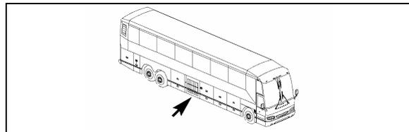
Tirer sur le bouton de déverrouillage situé à l'intérieur du compartiment à bagages à la droite du compartiment du condenseur pour entrouvrir la porte.
