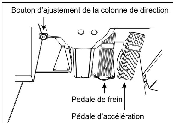
INCLINAISON ET RÉGLAGE TÉLESCOPIQUE 18436
