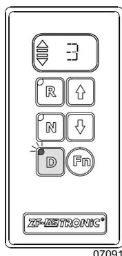
Si après relâchement du frein, un véhicule se déplace vers l'avant en position neutre «N» et que le conducteur appuie sur la touche «D», le système choisit un rapport adapté à la vitesse de déplacement.
