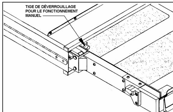
TIGES DE DÉVERROUILLAGE DE LA PLATE-FORME
