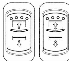
Basculer ces interrupteurs vers le bas pour descendre les pare-soleil et basculer vers le haut pour les remonter.
