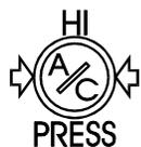
Lorsque la pression du système de climatisation est trop haute, ce témoin apparaît et le compresseur est débrayé. Quant au ventilateur du condenseur, il continue de fonctionner.
