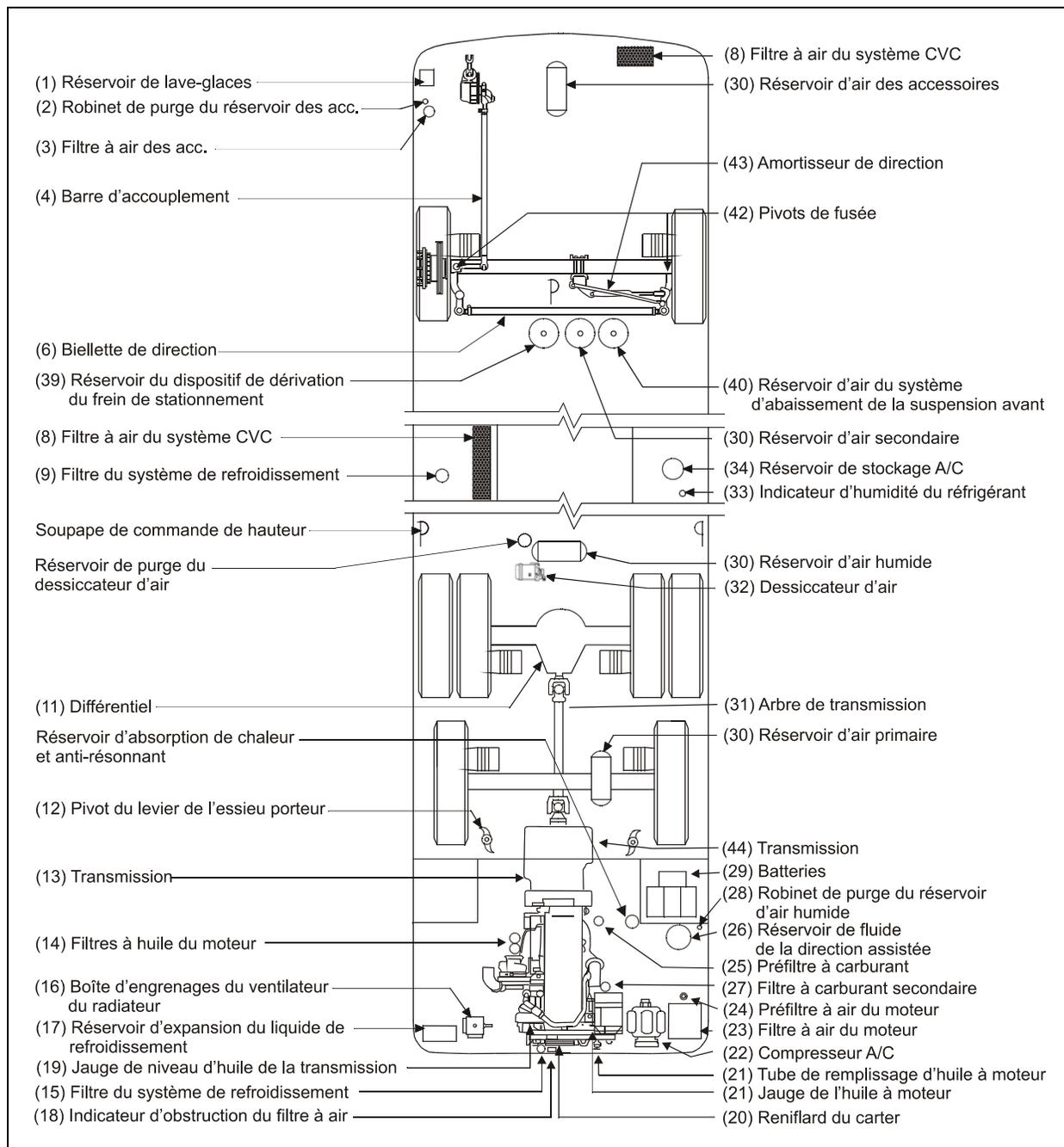
POINTS DE LUBRIFICATION ET D'ENTRETIEN POUR UN VÉHICULE AVEC ESSIEU AVANT RIGIDE (TYPIQUE)
