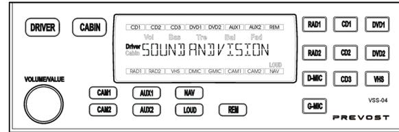
L'unité de commande «Sound Selector» VSS-04 permet au conducteur de sélectionner la musique d'ambiance ou la vidéo de divertissement et de contrôler de façon indépendante les réglages audio (volume, niveau des basses, des aigus, etc.) dans la section des passagers et la section du conducteur. Cette unité permet également de contrôler la radio, le lecteur DVD, le lecteur de vidéo cassette, le système de diffusion publique, les systèmes auxiliaires ou autres.
