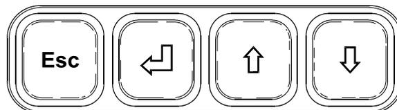
Utiliser les flèches vers le haut (↑) ou vers le bas (↓) pour mettre en évidence une fonction ou un réglage. De petites flèches apparaissent dans le coin droit supérieur ou inférieur de l'écran pour indiquer que de l'information supplémentaire est disponible en utilisant les flèches de défilement.
