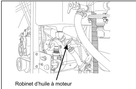
RÉSERVOIR AUXILIAIRE D'HUILE À MOTEUR 01050
