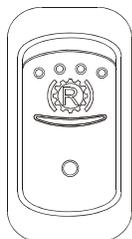
Basculer cet interrupteur pour activer le ralentisseur de la transmission. Voir le paragraphe «Ralentisseur de la transmission» dans ce chapitre.
