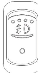
Des phares antibrouillard à halogène peuvent être installés sur votre véhicule. Ils augmentent la visibilité par temps brumeux et permettent une conduite plus sécuritaire. Basculer cet interrupteur pour les allumer.
