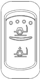
Basculer momentanément l'interrupteur vers le bas pour abaisser l'avant de l'autocar de 100 mm (4 pouces). Basculer l'interrupteur vers le haut pour ramener l'avant de l'autocar à sa position normale.
