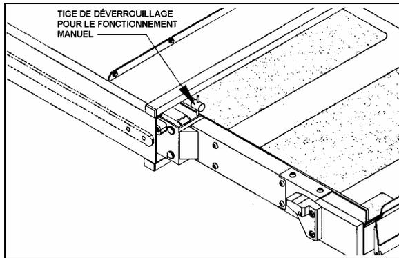
TIGES DE DÉVERROUILLAGE DE LA PLATE-FORME
