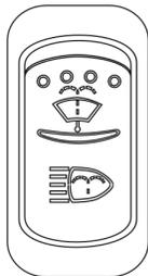
Basculer cet interrupteur vers le haut et maintenir enfoncé pour actionner les gicleurs de lave-glaces des essuie-glaces supérieurs. Les essuie-glaces sont automatiquement actionnés et s'arrêtent quelques secondes après le relâchement de l'interrupteur.
