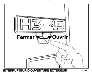
L'ouverture et la fermeture de la porte sont aussi contrôlées de façon pneumatique à partir de l'extérieur du véhicule par un interrupteur à 3 positions situé à gauche de la porte avant.
