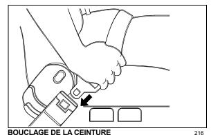
Remarque: La ceinture se boucle du côté droit sur le siège à suspension mécanique et du côté gauche sur le siège à suspension pneumatique.
