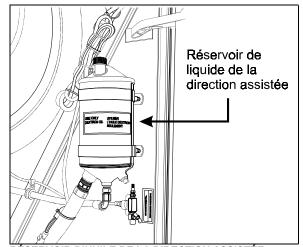
RÉSERVOIR D'HUILE DE LA DIRECTION ASSISTÉE, 71 CÔTÉ DROIT DU MOTEUR
