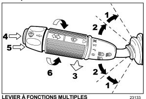
Le levier de commande à fonctions multiples sert à actionner les instruments suivants :
