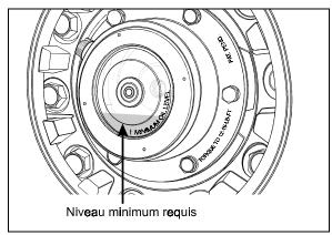
LUBRIFICATION DES ROULEMENTS
