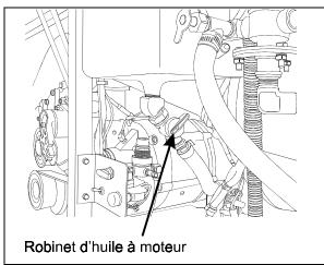
RÉSERVOIR AUXILIAIRE D'HUILE À MOTEUR
