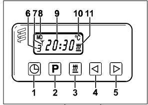
MINUTERIE DU SYSTÈME DE PRÉCHAUFFAGE DE MARQUE ESPAR: (1) Heure; (2) Présélection; (3) Chauffage; (4) Retour; (5) Aller; (6) Indication de la mémoire; (7) Symbole de la commande à distance; (8) Jour de la semaine ou jour présélectionné; (9) Heure réelle ou heure présélectionnée; (10) Indication de la température; (11) Indication du fonctionnement.
