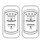
Basculer et maintenir l'interrupteur vers l'arrière pour descendre le pare-soleil gauche et vers l'avant pour le remonter. Faire de même avec le second interrupteur pour régler la hauteur du pare-soleil droit.
