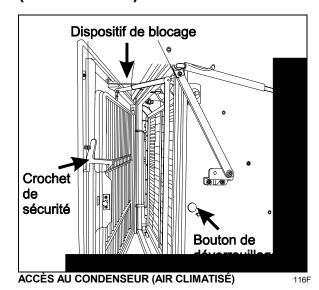
Tirer le bouton de déverrouillage situé à l'intérieur du compartiment à bagages adjacent, pour entrouvrir la porte. Appuver sur le levier d'ouverture de la porte pour ouvrir cette dernière. Attention: Refermer la du porte compartiment à bagages avant d'ouvrir complètement la porte du condenseur
