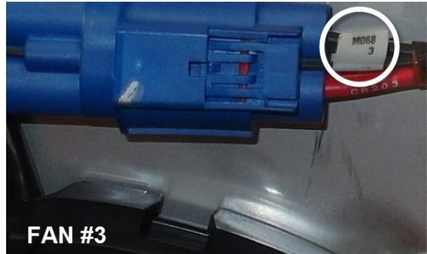
105. Installer les ventilateurs et les **protège-mains** sur le panneau dans la même disposition que sur l'image. **S'assurer de placer le ventilateur de sorte que le câble se trouve à la bonne position, 3 heures, 6 heures ou 12 heures, selon l'image à droite.**
