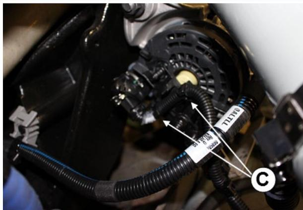
FIGURE 97 : C : ATTACHES EN NYLON #504016 (2x)
