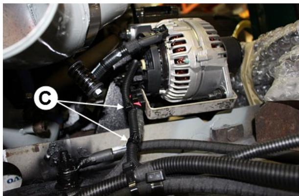
FIGURE 98 : C : ATTACHES EN NYLON #504016 (2x)
