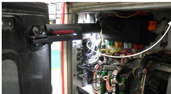
5. Installer l'interrupteur à bascule du klaxon.
