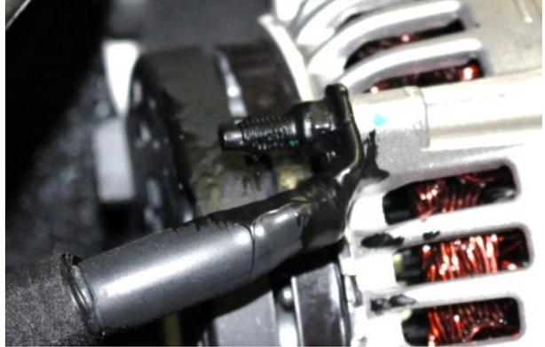
**FIGURE 135: GROUND CONNECTION ON THE ALTERNATOR**
