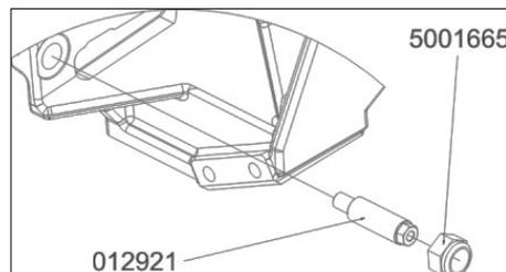
FIGURE 56: REAR VIEW – GROUND STUD
