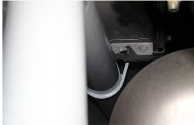
FIGURE 98: ENGINE INTAKE PIPE SUPPORT
