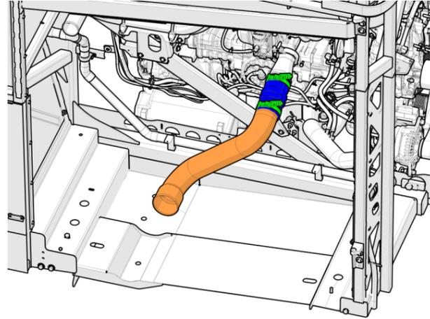
FIGURE 137: CONNECTION AT THE TURBO OUTLET ELBOW
