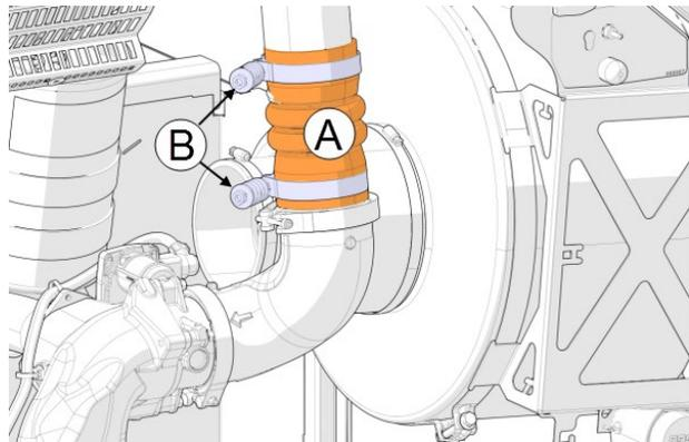
FIGURE 103: CONNECTION AT THE ENGINE INTAKE ELBOW
