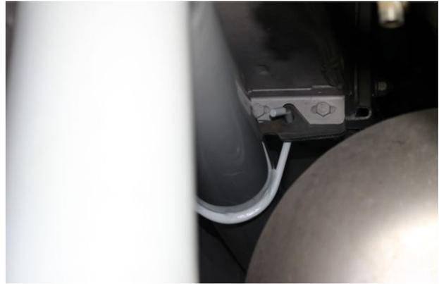
FIGURE 98: SUPPORT DE TUYAU D'ADMISSION DU MOTEUR
