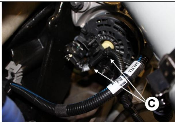
**FIGURE 125 : C : ATTACHES EN NYLON #504016 (2x)**
