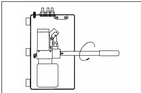
**ABAISSEMENT DE LA PLATE-FORME DE FAÇON MANUELLE** 23274
