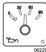
Cet instrument indique la pression d'huile du moteur. Une lecture normale devrait varier entre 345 et 483 kPa (50 et 70 lb/po<sup>2</sup>) à une vitesse de 90 km/h (55 mi/h). Une DEL (diode électroluminescente) de basse pression d'huile (coin droit inférieur) s'allume lorsque la pression d'huile baisse sous 345 kPa (50 psi).
