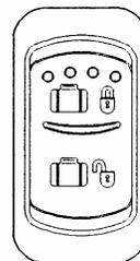
Basculer l'interrupteur vers l'avant pour verrouiller les compartiments à bagages et la porte d'accès au côté droit du moteur et vers l'arrière pour les déverrouiller.
