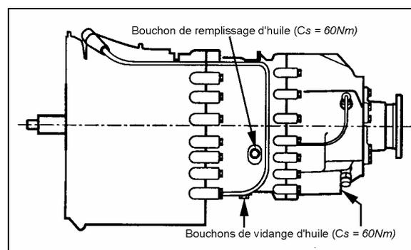
ORIFICE DE REMPLISSAGE TRANSMISSION ZF 07XXX
