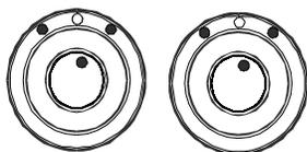
Tourner le bouton vers la gauche pour l'ajustement du miroir plat du rétroviseur et vers la droite pour l'ajustement du miroir de type convexe. Pivoter ensuite la commande dans le sens approprié afin d'orienter le rétroviseur à l'angle désiré.
