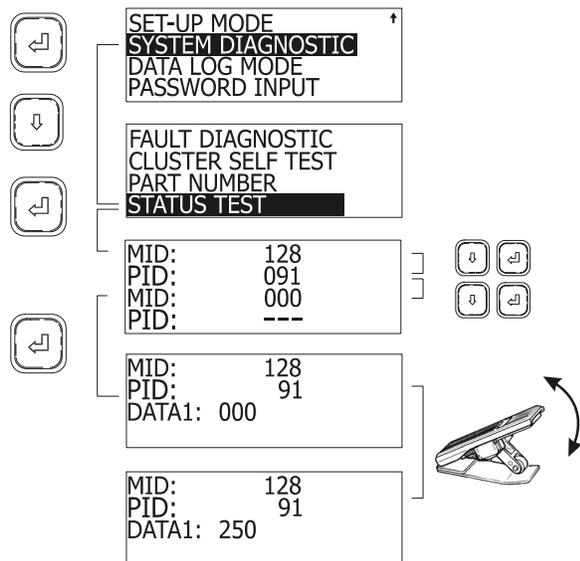
Dans cet exemple, une pédale d'accélérateur en bon état de marche envoie un signal linéaire et continu (sans dents de scies) à l'ECU. Ce signal apparaît sous forme de données à l'écran du MCD. Un mouvement de la pédale affiche des valeurs entre 000 (puissance minimum) et 250 (puissance maximum).
