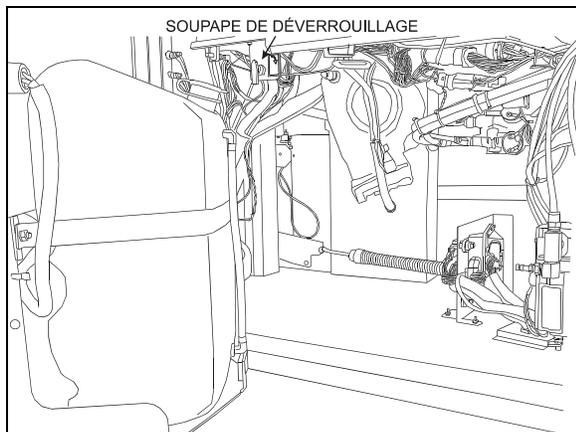
SOUPAPE DE DÉVERROUILLAGE
