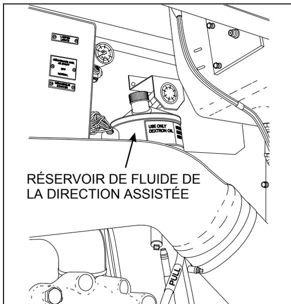
RÉSERVOIR DE FLUIDE DE LA DIRECTION ASSISTÉE 14044
