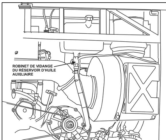
RÉSERVOIR AUXILIAIRE D'HUILE À MOTEUR 01063
