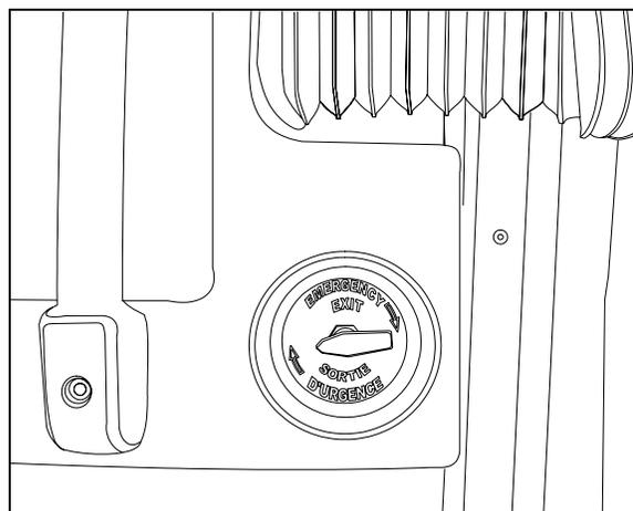
SOUPAPE INTÉRIEURE D'OUVERTURE D'URGENCE<sup>12164</sup>
