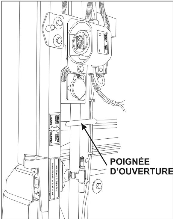
OUVERTURE DES PORTES D'ACCÈS À L'ARRIÈRE DU MOTEUR 18371
