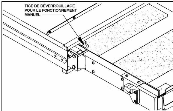
TIGES DE DÉVERROUILLAGE DE LA PLATE-FORME
