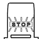
Ce témoin s'allume lorsque les feux stop arrière sont allumés. Ceci se produit lorsque l'interrupteur DECEL du régulateur de croisière, les freins de service, le frein de stationnement, le frein moteur ou le ralentisseur de la transmission sont mis en fonction.
