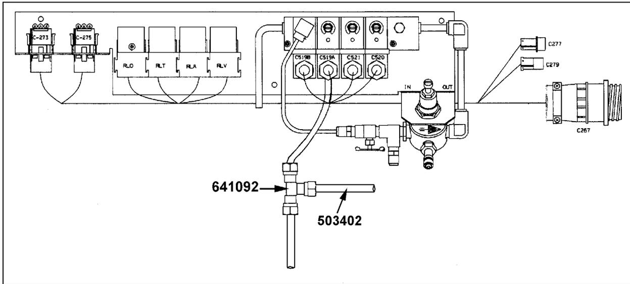
FIGURE 2: LOCATION OF MANIFOLD BEHIND DASHBOARD FINISHING PANEL
