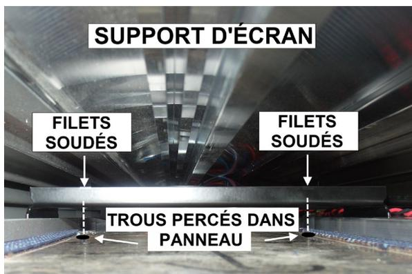
5. Fixer les deux attaches de l'écran en ciseau au panneau supérieur en utilisant la plaque adaptateur **7771116**, les vis **5001923** et les rondelles **502709** fournies.
