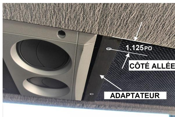
2. En utilisant la plaque adaptateur comme guide, percer deux trous de 5/16po dans le panneau supérieur.
