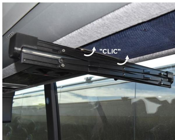
7. Remettre en place la console supérieure pour terminer l'installation.
