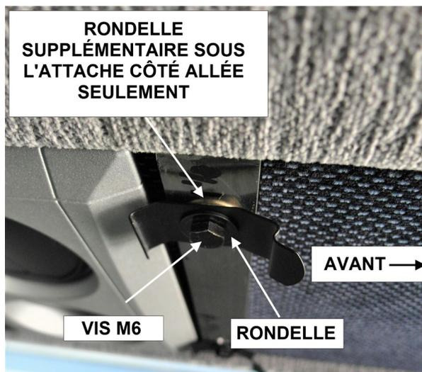
6. Clipser l'écran ciseau en place et vérifier que son ajustement est correct. L'écran devrait se déployer et se rétracter librement sans qu'il y ai contact avec la fenêtre ou le pare-soleil latéral. Ajuster le positionnement latéral au besoin.
