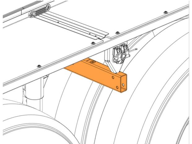
3. Fixer le garde-boue 460566P avec les vis 5001185(4x), les rondelles 500270(8x) et les écrous 5001787(4x).
