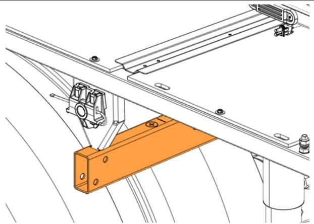
3. Fixer le garde-boue 460565P avec les vis 5001185(4x), les rondelles 500270(8x) et les écrous 5001787(4x).
