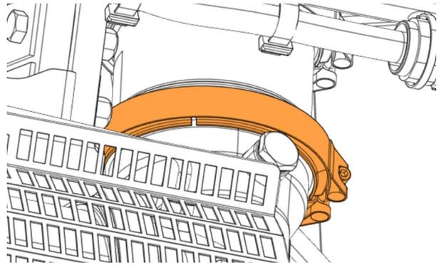
5. Meuler les projections de soudure à la sortie du système de filtre à particules.
