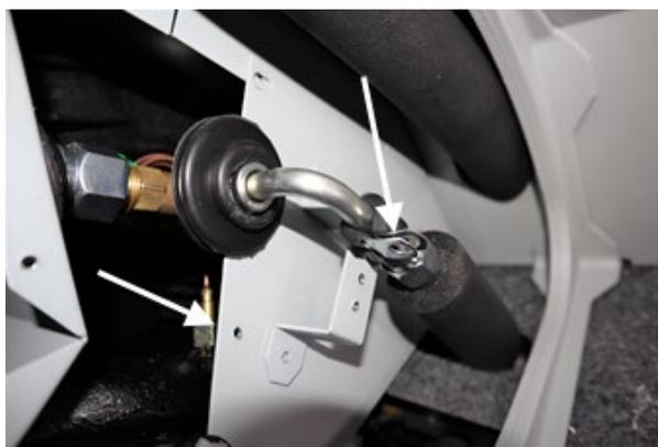
6. Débrancher le tuyau de drainage à l'arrière de l'unité AC.
