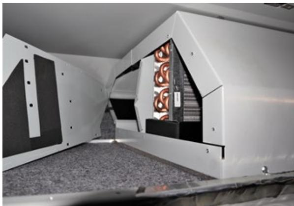
5. Retirer le couvercle de l'autre côté de l'unité AC (couvercle en deux pièces).
