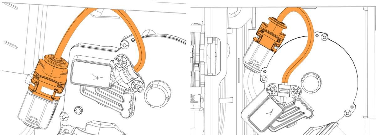
5. Vérifier si le connecteur a un bouchon dans la cavité vide.
