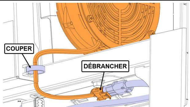
5. Enrubanner le filage ensemble jusqu'à 10mm avant le connecteur avec du ruban adhésif en tissu 564099.
