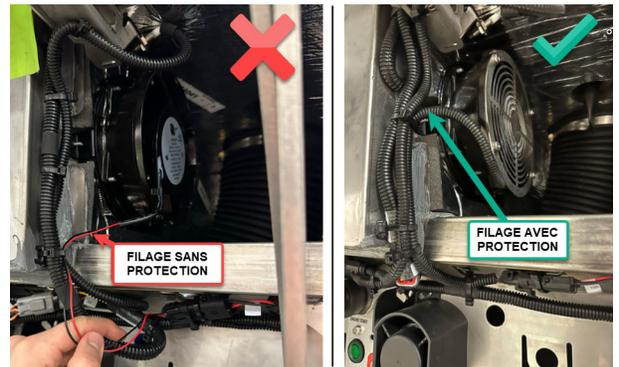
4. Débrancher le ventilateur de toilette et couper l'attache.
