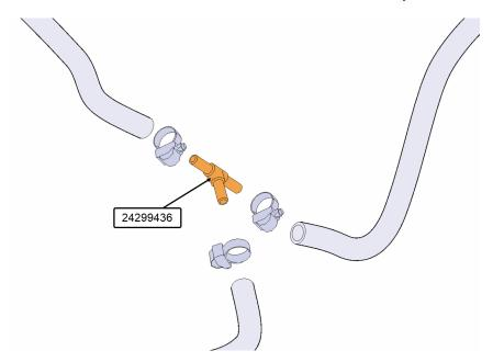
10) Localiser le raccord d'extraction du liquide de refroidissement sous le véhicule. Retirer le capuchon protecteur. Brancher la machine de récupération du liquide de refroidissement sur le raccord. Remplir le liquide de refroidissement.
