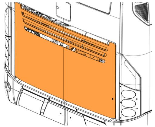
2) Retirer le couvercle d'encapsulation sous le moteur pour vidanger le liquide de refroidissement du moteur.
