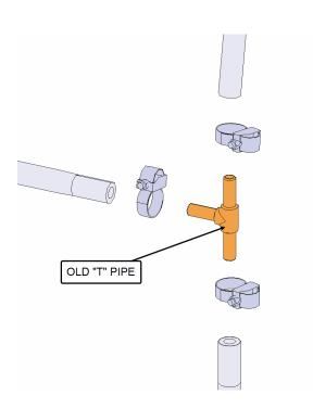
6) Installer le nouveau raccord en "T" 24299436 sur les tuyaux avec des colliers (3x).
