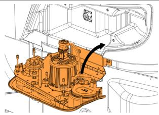
14. Fixer l'ensemble de la lampe à l'aide des vis de fixation (des deux côtés).
