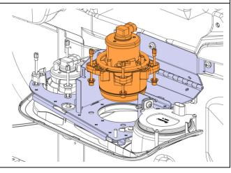
8. Retirer les dispositifs de réglage des phares (3x) des phares neufs 930040 (2x) et les mettre au rebut.
