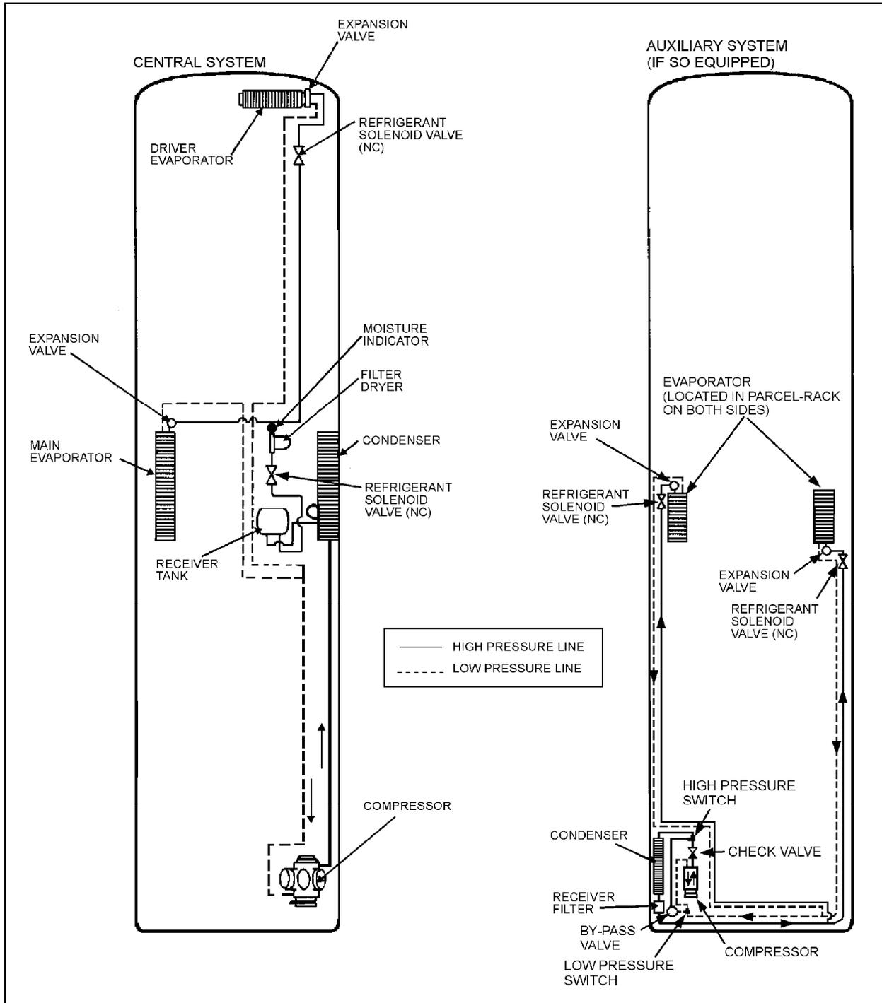
FIGURE 17: REFRIGERANT CIRCUIT (CENTRAL AND AUXILIARY SYSTEMS)
