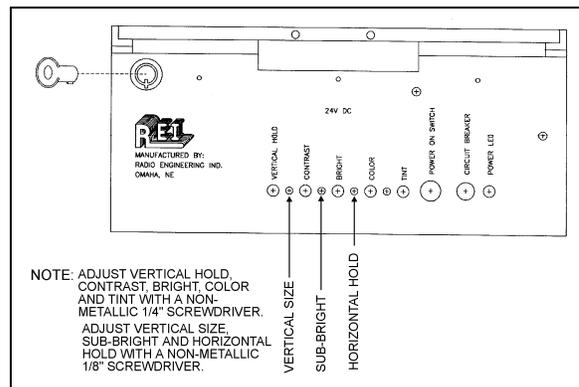
FIGURE 13: MONITOR HOUSING REAR PANEL 23076
