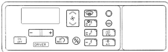
FIGURE 4: DRIVER'S HVAC SYSTEM CONTROL UNIT 22184
