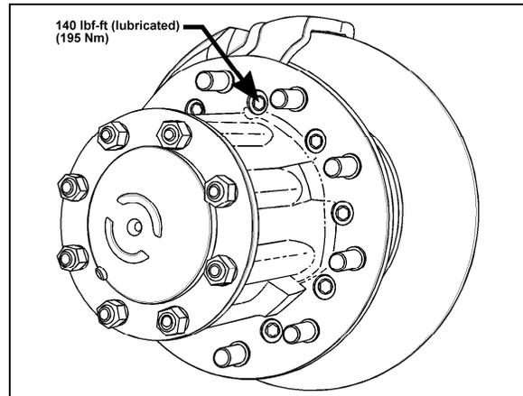
FIGURE 39: TORQUE SPECIFICATION 12149
