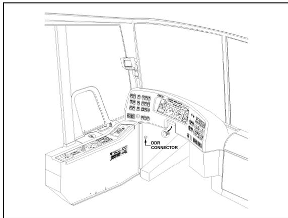
FIGURE 11: DDR CONNECTOR LOCATION IN DRIVER'S AREA
