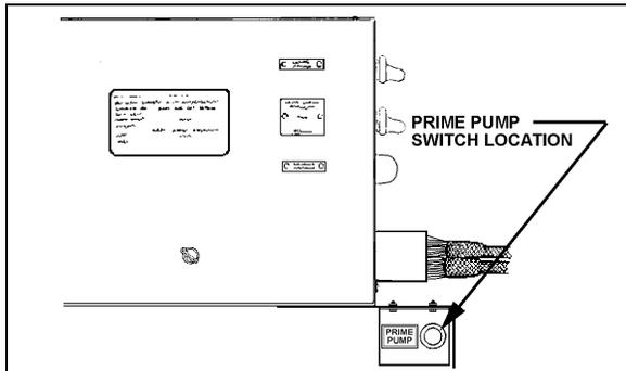
FIGURE 9: PRIME PUMP SWITCH LOCATION 01037
