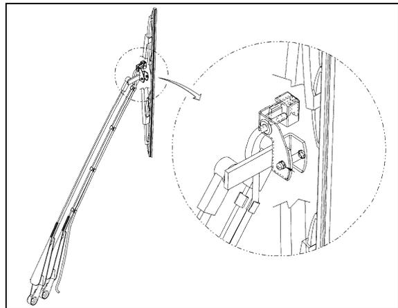
FIGURE 33: WINDSHIELD WIPER ( DRIVER SIDE) 23225
