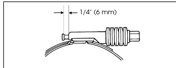
FIGURE 3: CONSTANT-TORQUE CLAMP 05037
