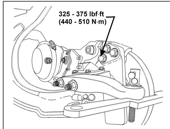
FIGURE 38: TORQUE SPECIFICATION 12145
