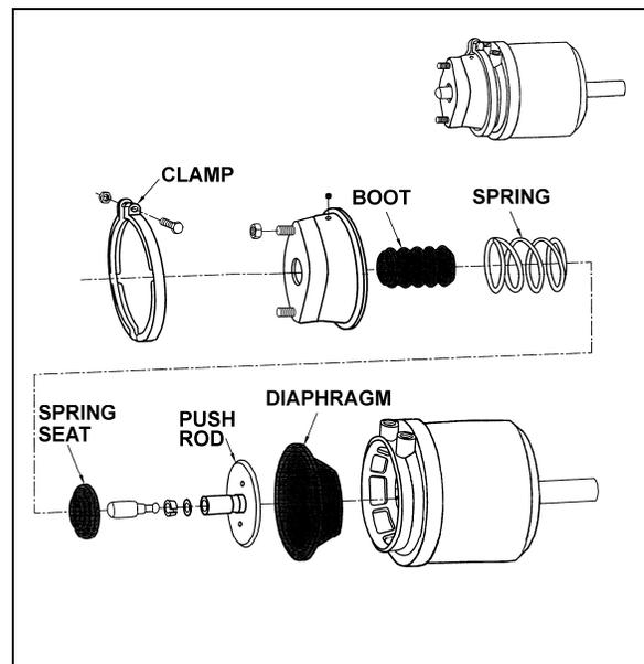
FIGURE 42: TAG AXLE BRAKE AIR CHAMBER 12126
