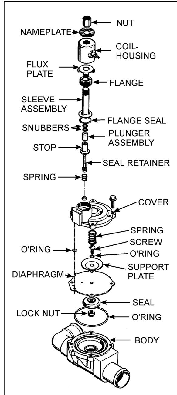
FIGURE 46: CENTRAL WATER SOLENOID VALVE 22183
