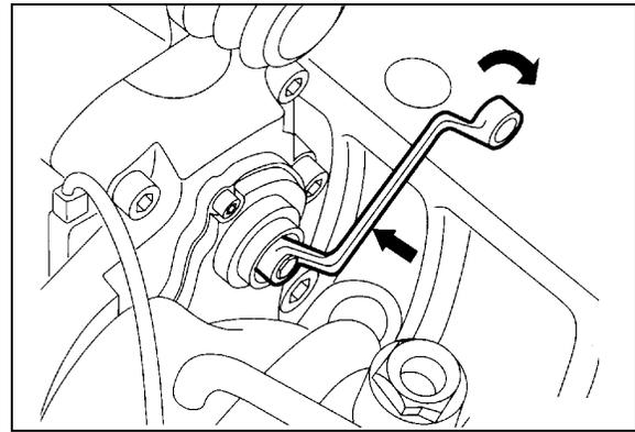
FIGURE 27: BOX WRENCH ON ADJUSTER PINION 12118
