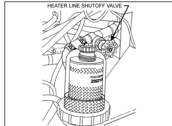
FIGURE 41: HEATER LINE SHUTOFF VALVE 05070
