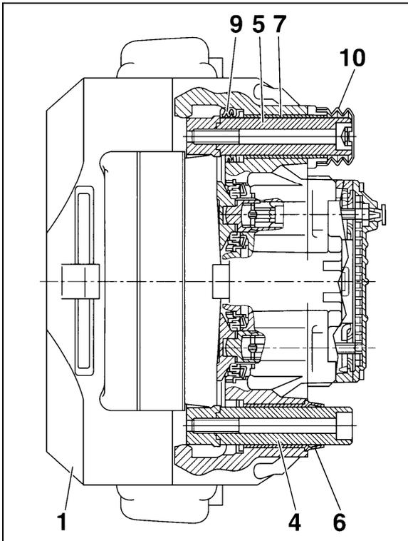
FIGURE 33: CALIPER GUIDANCE 12114
