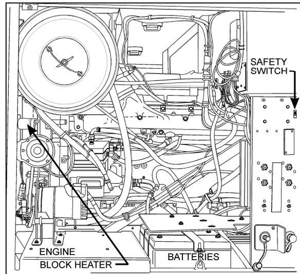
FIGURE 51: ELECTRIC HEATER PLUG LOCATION 18354
