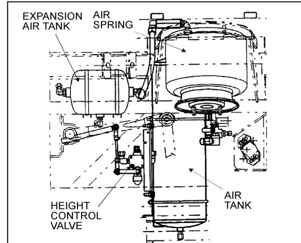
FIGURE 22: HEIGHT CONTROL VALVE LOCATION 16057
