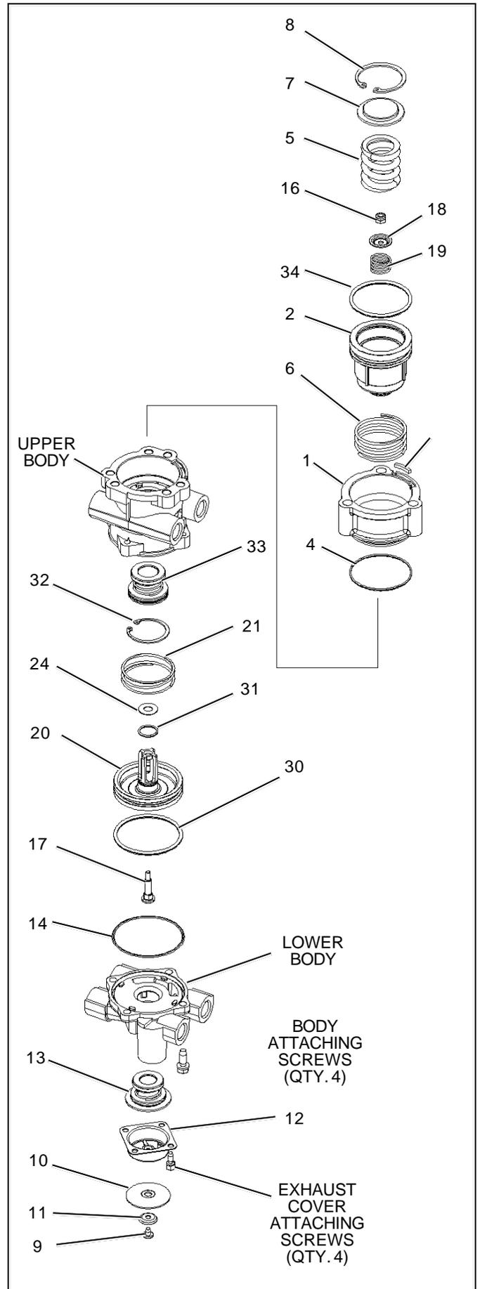
FIGURE 6 - E-10P BRAKE VALVE - EXPLODED VIEW
