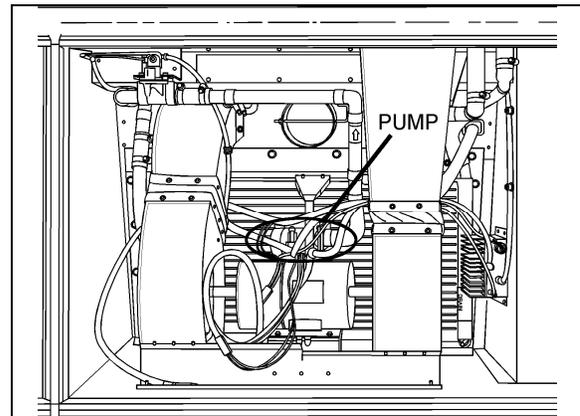
FIGURE 47: PUMP LOCATION (SHELL)
