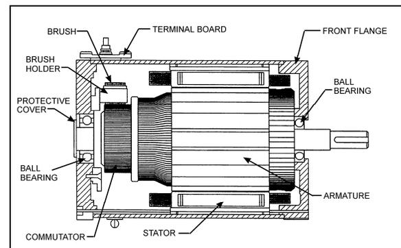
**FIGURE 27: CONDENSER FAN MOTOR**
