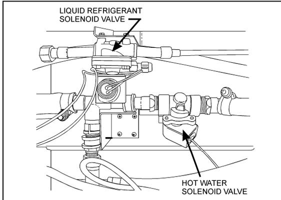
FIGURE 30: DRIVER'S EVAPORATOR LIQUID SOLENOID VALVE 22181
