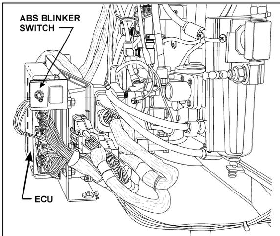
FIGURE 44: ABS BLINKER SWITCH & ECU LOCATION 12147
