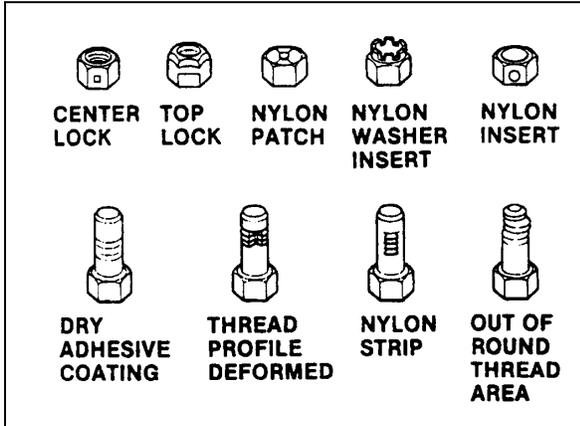
FIGURE 13 : SELF-LOCKING FASTENERS 00004
