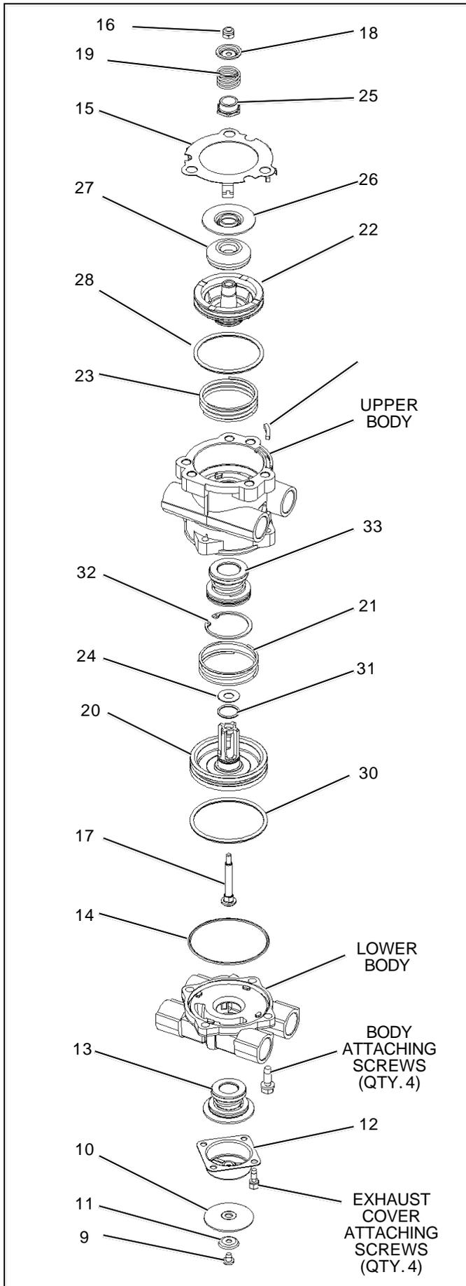
FIGURE 5 - E-8P BRAKE VALVE - EXPLODED VIEW
