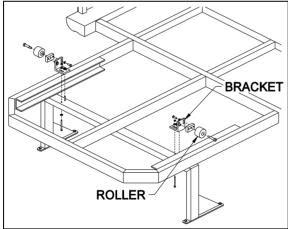
FIGURE 10 : REAR SLIDE-OUT BED ROLLER
