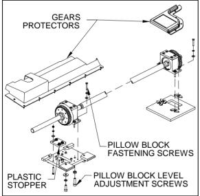
FIGURE 26 : FRONT SLIDE-OUT SLIDING PAD LEVELLING
