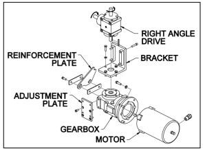
FIGURE 24 : FRONT SLIDE-OUT MOTOR ASSEMBLY
