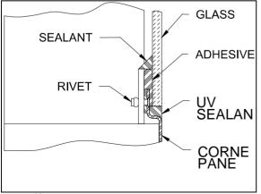
FIGURE 48 : WINDOW LOCATED OVER THE CORNER PANEL
