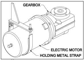
FIGURE 23 : ELECTRIC MOTOR
