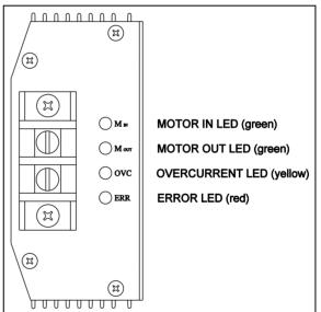
FIGURE 38 : MOTOR CONTROLLER LED PANEL
