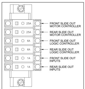
FIGURE 39 : SLIDE-OUT BREAKERS
