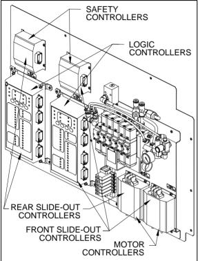
FIGURE 37 : SLIDE-OUT ELECTRICAL PANEL
