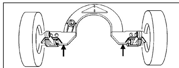
POINTS DE LEVAGE SOUS L'ESSIEU PORTEUR<sup>0EH3B764</sup>
