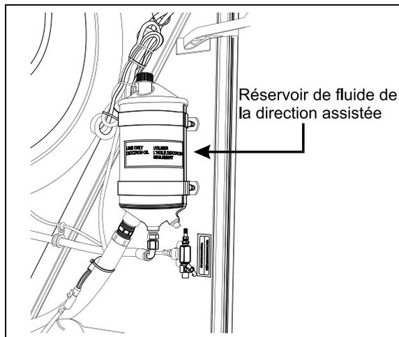
RÉSERVOIR DE FLUIDE DE LA DIRECTION ASSISTÉE 14043
