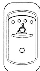
Basculer l'interrupteur vers le bas pour démarrer le système d'élévation de fauteuils roulants. Voir le chapitre «Autres caractéristiques» pour plus de détails et le manuel de l'élévateur fourni dans la boîte de publications techniques.
