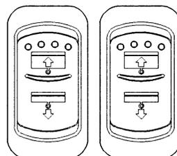
Basculer et maintenir l'interrupteur vers l'arrière pour descendre le pare-soleil gauche et vers l'avant pour le remonter. Faire de même avec le second interrupteur pour régler la hauteur du pare-soleil droit.
