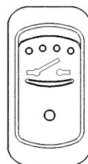
Les deux systèmes électriques de 12 volts et 24 volts sont mis sous tension à l'aide de cet interrupteur. Un témoin s'allume sur le tableau de bord lorsque la clé du commutateur d'allumage est à la position OFF.
