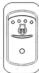
Basculer l'interrupteur vers le bas pour mettre en fonction le préchauffeur qui, au besoin, s'ajoute au système de chauffage central. Le système de préchauffage se met en marche et s'arrête automatiquement selon la température du liquide de refroidissement. Consulter le chapitre «Autres caractéristiques» pour plus de détails
