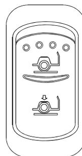
Basculer l'interrupteur vers l'arrière pour abaisser l'avant de l'autocar de 100 mm (4 pouces). Relâcher l'interrupteur pour relever l'avant de l'autocar.
