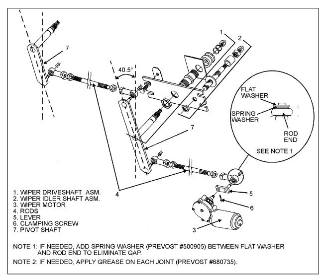
FIGURE 35: LOWER WINDSHIELD WIPER INSTALLATION
