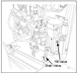
FIGURE 28: FRONT VALVE LOCATION
