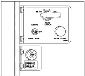
FIGURE 10: PRIME PUMP SWITCH LOCATION
