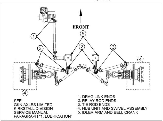
FIGURE 12: LUBRICATION FITTINGS' LOCATION DIAGRAM
