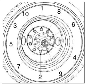
FIGURE 2: TIGHTENING SEQUENCE
