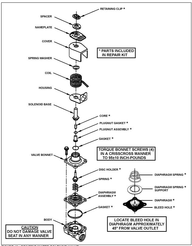
FIGURE 43: DRIVER'S WATER SOLENOID VALVE
