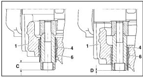
FIGURE 29: BRAKE PAD CHECK
