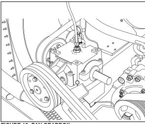
FIGURE 12: FAN GEARBOX
