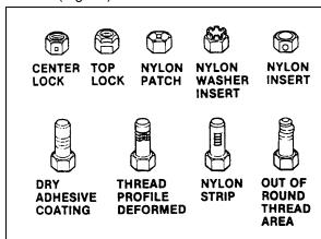
FIGURE 12 : SELF-LOCKING FASTENERS
