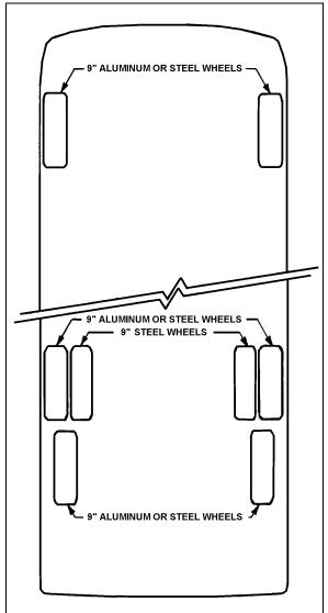
FIGURE 1: ALUM/STEEL WHEEL ARRANGEMENT 13001H3
