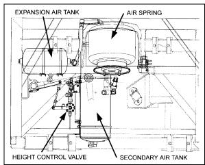
FIGURE 23: HEIGHT CONTROL VALVE LOCATION
