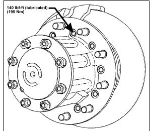
FIGURE 38: TORQUE SPECIFICATION
