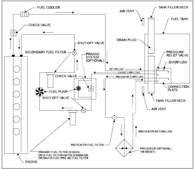
FIGURE 1: FUEL SYSTEM SCHEMATIC
