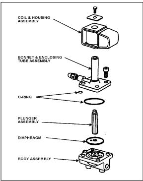
FIGURE 32: REFRIGERANT SOLENOID VALVE
