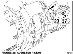
FIGURE 25: ADJUSTER PINION
