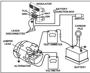
FIGURE 30: REGULATOR VOLTAGE TEST (UNDERCHARGED BATTERY)
