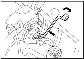
FIGURE 26: BOX WRENCH ON ADJUSTER PINION
