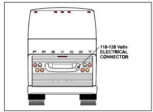
FIGURE 36: ELECTRIC HEATER PLUG LOCATION
