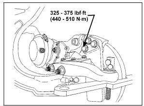
FIGURE 37: TORQUE SPECIFICATION
