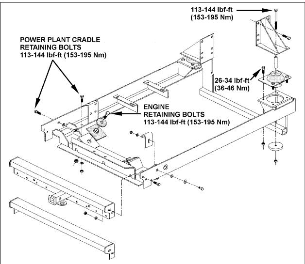
FIGURE 18: POWER PLANT CRADLE INSTALLATION
