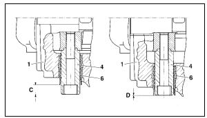
FIGURE 22: BRAKE PAD CHECK
