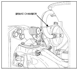
FIGURE 40: RIGID SUSPENSION FRONT AXLE BRAKE AIR CHAMBER 12158
