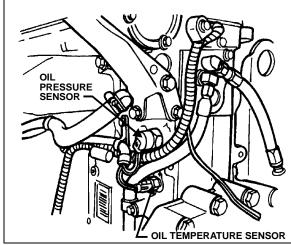
FIGURE 9: CYLINDER BLOCK
