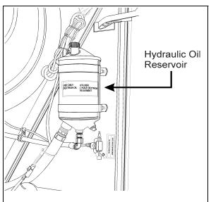
POWER STEERING HYDRAULIC FLUID TANK 14043
