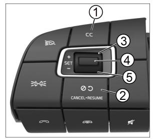
FIGURE 38: CRUISE CONTROL BUTTONS
