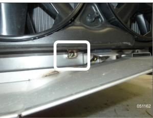
FIGURE 14: FAN SHROUD TOP & BOTTOM HOLD-DOWN SCREWS
