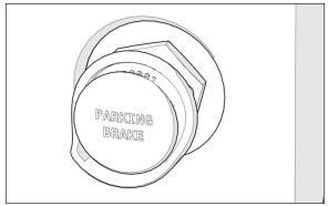
FIGURE 12: PARKING BRAKE CONTROL KNOB
