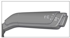
FIGURE 29: ENGINE BRAKE CONTROL STALK
