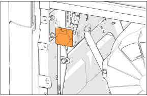
FIGURE 5: ENGINE BLOCK HEATER CONNECTOR (TYPICAL)
