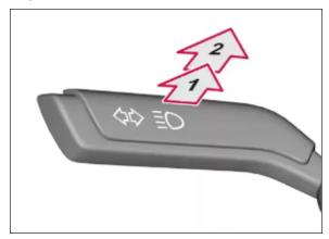
FIGURE 26: HIGH BEAM CONTROL
