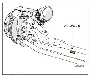
FIGURE 9: I-BEAM FRONT AXLE
