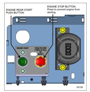
FIGURE 1: TYPICAL ENGINE STOP/ IGNITION INTERLOCK BUTTON
