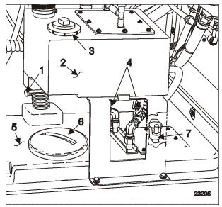
FIGURE 2: DUAL LAVATORY WASTE WATER TANK OPTION
