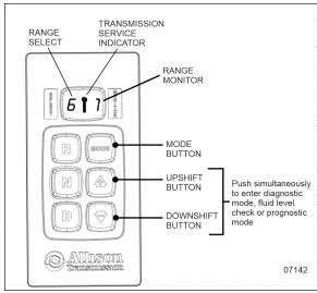
FIGURE 55: ALLISON PUSHBUTTON SHIFT SELECTOR
