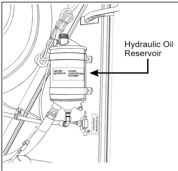
POWER STEERING HYDRAULIC FLUID TANK 14043
