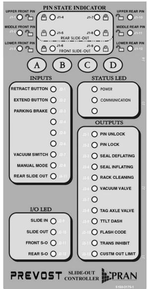
SLIDE-OUT LOGIC CONTROLLER INTERFACE DISPLAY
