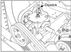
RADIATOR FAN GEARBOX OIL LEVEL DIPSTICK
