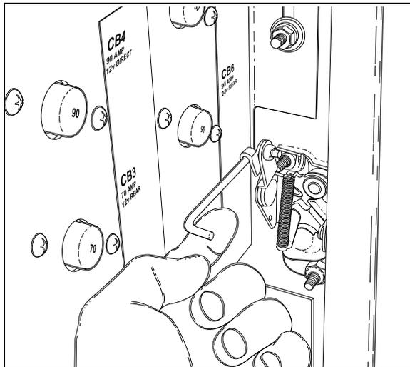
LEVER IN ENGINE COMPARTMENT R.H. SIDE DOOR
