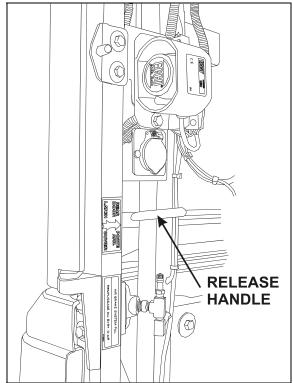
OPENING THE ENGINE COMPARTMENT REAR DOORS FROM R.H. SIDE DOOR 18547
