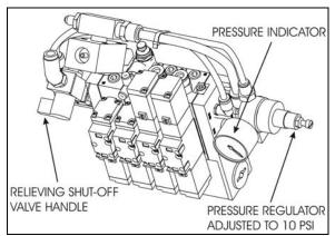
**INFLATABLE SEAL RELIEVING SHUT-OFF VALVE**
