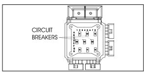
VEC CIRCUIT BREAKERS ON SLIDE-OUT CONTROL PANEL
