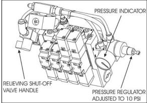
**INFLATABLE SEAL RELIEVING SHUT-OFF VALVE**
