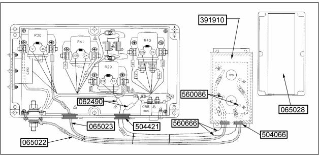
FIGURE 4: CABLE ROUTING BETWEEN A/C JUNCTION BOX AND CIRCUIT BREAKER BOX
