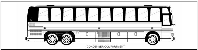
FIGURE 1: CONDENSER COMPARTMENT LOCATION (TYPICAL)
