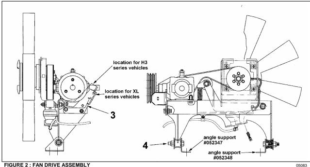
FIGURE 2 : FAN DRIVE ASSEMBLY
