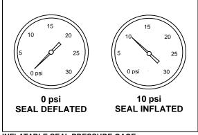
INFLATABLE SEAL PRESSURE GAGE
