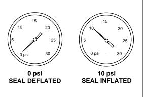
INFLATABLE SEAL PRESSURE GAGE
