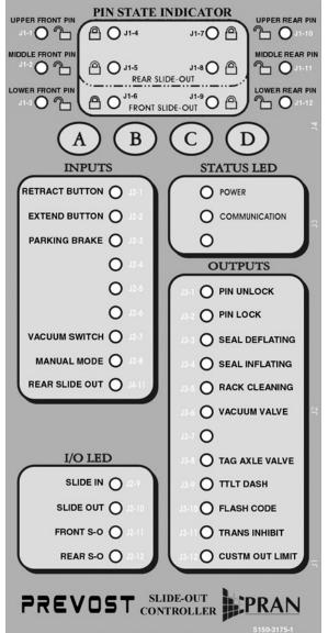
SLIDE-OUT LOGIC CONTROLLER INTERFACE DISPLAY
