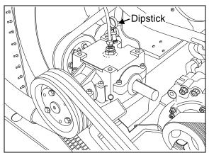
RADIATOR FAN GEARBOX OIL LEVEL DIPSTICK 05062
