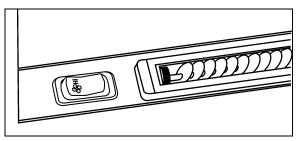
NAVIGATOR'S AIR REGISTER & FAN SPEED SELECTOR
