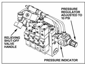
**INFLATABLE SEAL RELIEVING SHUT-OFF VALVE**
