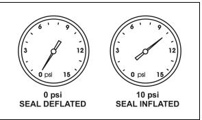
INFLATABLE SEAL PRESSURE GAGE
