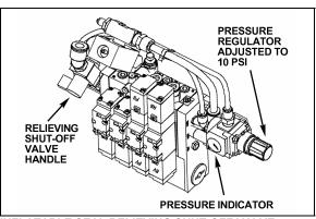
**INFLATABLE SEAL RELIEVING SHUT-OFF VALVE**
