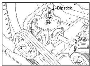
RADIATOR FAN GEARBOX OIL LEVEL DIPSTICK 0506
