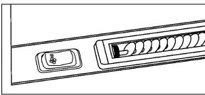
NAVIGATOR'S AIR REGISTER & FAN SPEED CONTROL SWITCH 22286
