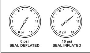
INFLATABLE SEAL PRESSURE GAGE
