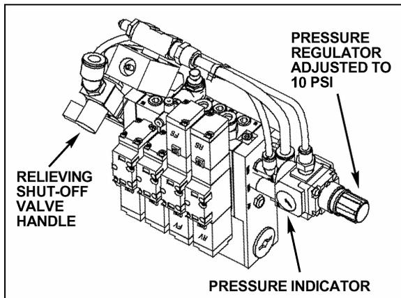
**INFLATABLE SEAL RELIEVING SHUT-OFF VALVE**
