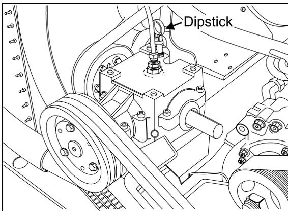
**RADIATOR FAN GEARBOX OIL LEVEL DIPSTICK** 05062
