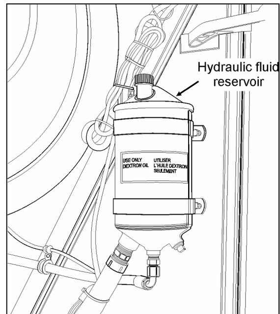
POWER STEERING HYDRAULIC FLUID TANK 14043
