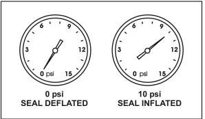
INFLATABLE SEAL PRESSURE GAGE
