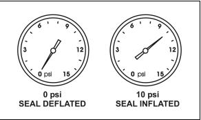
INFLATABLE SEAL PRESSURE GAGE
