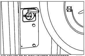
110-120 VOLTS BLOCK HEATER CONNECTOR 06650
