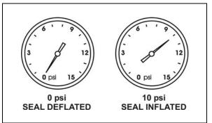
INFLATABLE SEAL PRESSURE GAGE
