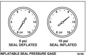
INFLATABLE SEAL PRESSURE GAGE
