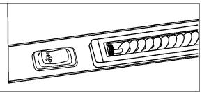
NAVIGATOR'S AIR REGISTER & FAN SPEED CONTROL SWITCH
