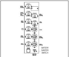
**MAIN CIRCUIT BREAKERS 12 & 24 VOLTS**
