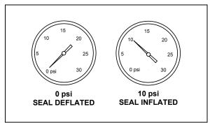
INFLATABLE SEAL PRESSURE GAGE
