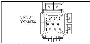
VEC CIRCUIT BREAKERS ON SLIDE-OUT CONTROL
