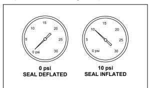
INFLATABLE SEAL PRESSURE GAGE
