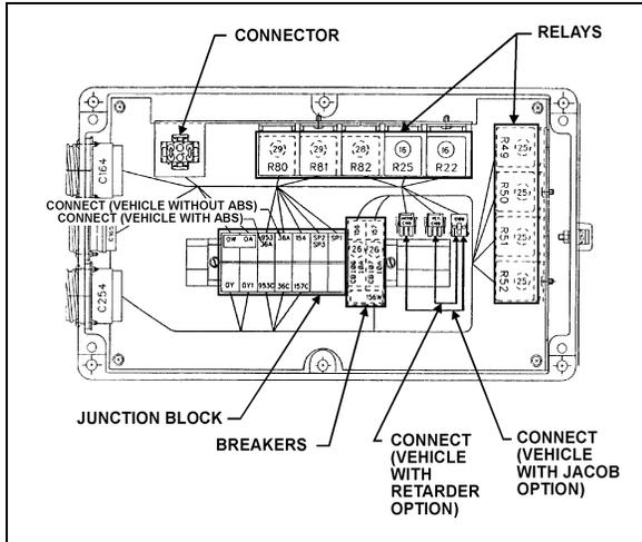
FIGURE 26: DDEC III JUNCTION BOX 06121
