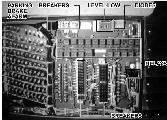
FIGURE 46: FRONT ELECTRICAL COMPARTMENT 06129
