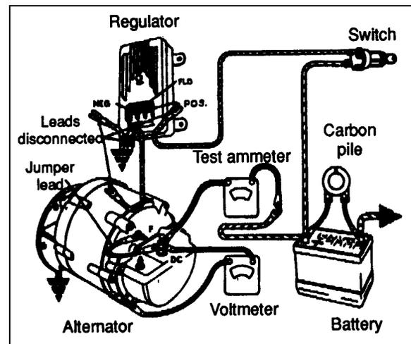
FIGURE 84: REGULATOR VOLTAGE TEST (UNDERCHARGED BATTERY) 06080
