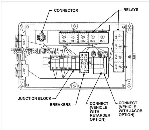
FIGURE 50: DDEC III JUNCTION BOX 06121
