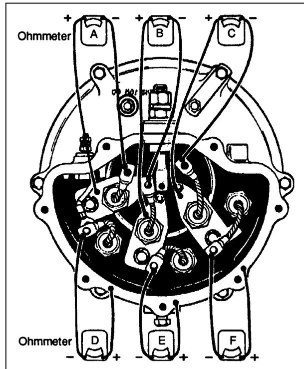
FIGURE 69: DIODES TEST
