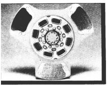
FIGURE 10 DAMPENED 3-BUTTON CERAMIC 14" ONLY
