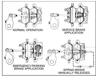
FIGURE 17: BRAKE AIR CHAMBERS OPERATION 12047
