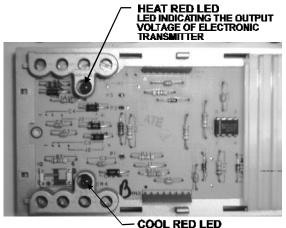
FIGURE 8: ELECTRONIC TRANSMITTER 22025
