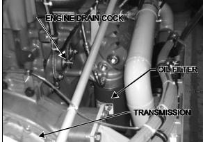
FIGURE 7: RIGHT REAR CORNER OF ENGINE 05027
