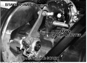
FIGURE 14: DRUM BRAKE ASSEMBLY
