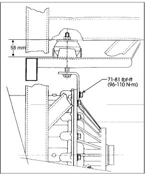
FIGURE 17: RUBBER DAMPER TOLERANCE 07014
