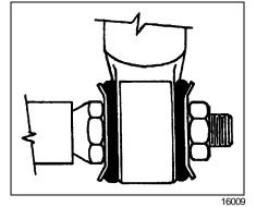
FIGURE 5: TYPICAL SHOCK ABSORBER SETUP
