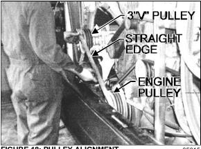
FIGURE 18: PULLEY ALIGNMENT
