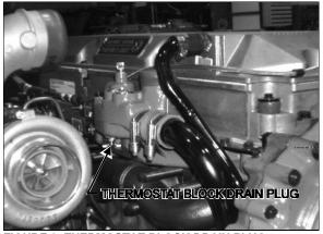
FIGURE 9: THERMOSTAT BLOCK DRAIN PLUG 05029
