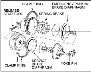
FIGURE 18: BRAKE AIR CHAMBERS ASSEMBLY 12048
