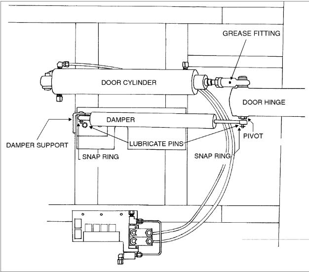
FIGURE 12: DOOR CYLINDER AND DAMPER 18160
