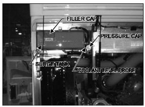
FIGURE 2: COOLING SYSTEM SURGE TANK 05024
