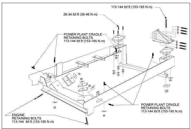
FIGURE 18: POWER PLANT CRADLE INSTALLATION
