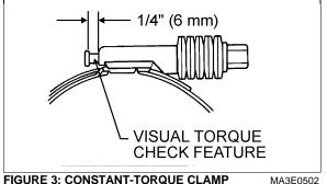
FIGURE 3: CONSTANT-TORQUE CLAMP
