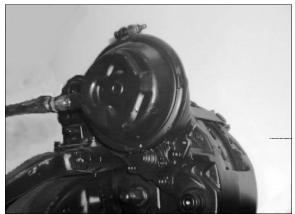
FIGURE 19: FRONT AXLE BRAKE AIR CHAMBER 12049
