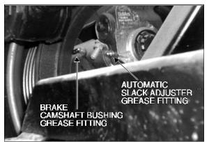
FIGURE 15: GREASE FITTINGS LOCATION
