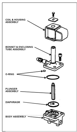
FIGURE 25: REFRIGERANT SOLENOID VALVE 22044
