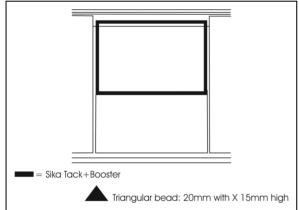
FIGURE 57 : FACE FIXED HALF-WINDOW INSTALLATION – SIKA TACK+BOOSTER
