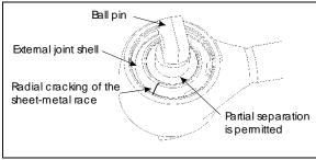
Figure 15: A-ARM BALL JOINTS
