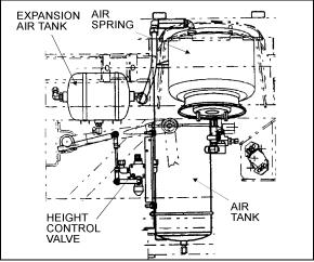
FIGURE 27: HEIGHT CONTROL VALVE LOCATION 16057
