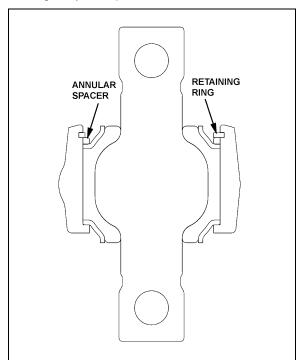
FIGURE 14: LOWER A-ARM BALL JOINTS
