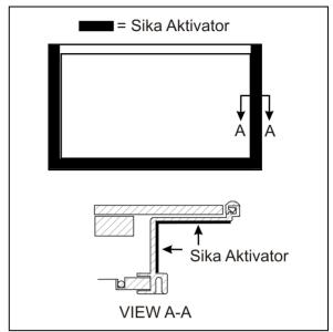
FIGURE 71: SLIDING WINDOW - SIKA AKTIVATOR
