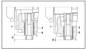
FIGURE 23: BRAKE PAD CHECK
