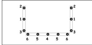
FIGURE 67 : CORRECT TIGHTENING SEQUENCE
