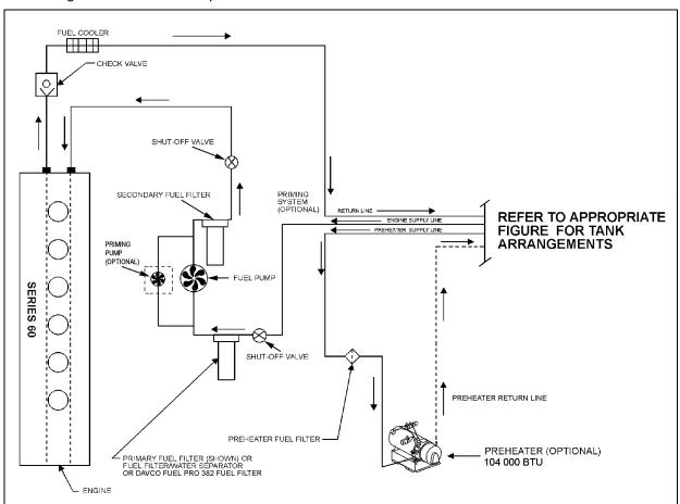
FIGURE 1: FUEL SYSTEM SCHEMATIC
