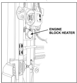
FIGURE 47: ELECTRIC HEATER PLUG LOCATION 18354
