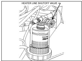
FIGURE 48: HEATER LINE SHUTOFF VALVE
