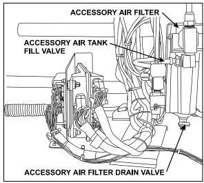
FIGURE 32: FRONT VALVE LOCATION
