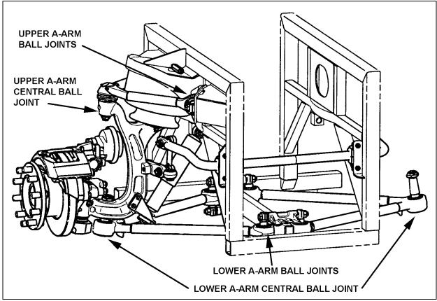
FIGURE 14: BALL JOINTS LOCATION
