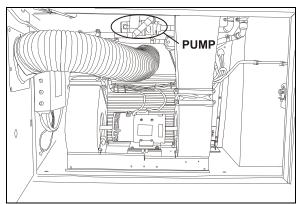
FIGURE 57: PUMP LOCATION (CENTRAL A/C)
