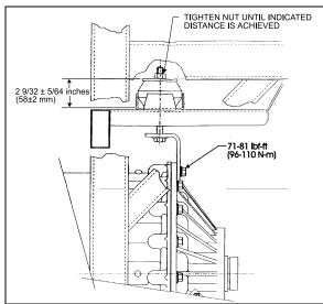
FIGURE 19: RUBBER DAMPER TOLERANCE
