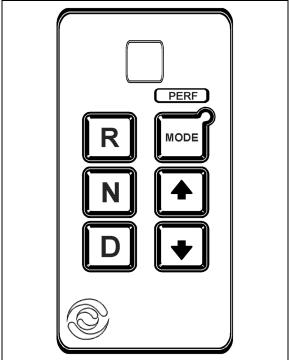
FIGURE 2: WORLD TRANSMISSION CONTROL PAD 07025
