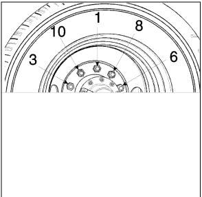
FIGURE 2: TIGHTENING SEQUENCE
