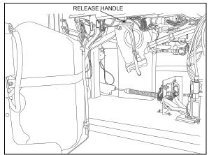
FIGURE 25: FRONT BUMPER RELEASE HANDLE
