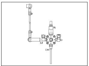
FIGURE 29: FRONT HEIGHT CONTROL VALVE
