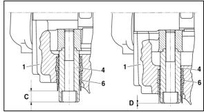
FIGURE 29: BRAKE PAD CHECK
