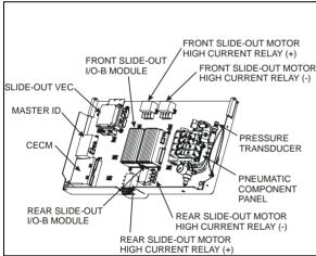
FIGURE 35 : SLIDE-OUT CONTROL PANEL
