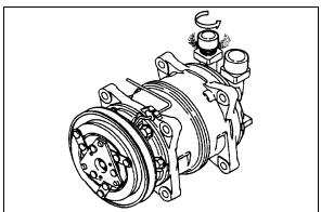
FIGURE 36: LOOSENING THE DISCHARGE SIDE CONNECTOR'S CAP
