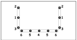
FIGURE 74: CORRECT TIGHTENING SEQUENCE
