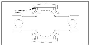
FIGURE 16: UPPER A-ARM BALL JOINT
