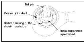
FIGURE 13: A-ARM BALL JOINTS
