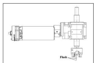
FIGURE 19: CLAMPING HUB POSITION ON GEARBOX SHAFT
