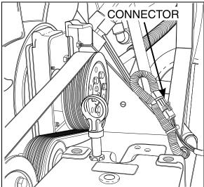
FIGURE 16: ELECTRIC FAN-CLUTCH CONNECTOR 010XX
