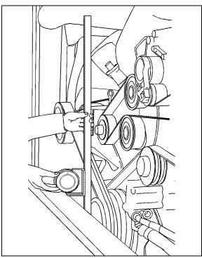
FIGURE 19: PULLEY VERTICAL ANGLE
