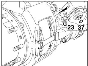
FIGURE 26: ADJUSTER PINION
