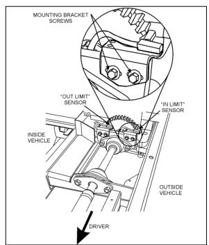
FIGURE 37: FRONT SLIDE-OUT SENSORS
