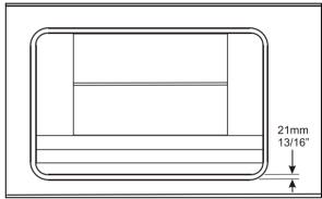
FIGURE 21: SLIDE-OUT LEVEL ADJUSTEMENT
