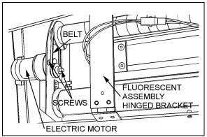
FIGURE 22: DESTINATION SIGN-ELECTRIC MOTOR 23034
