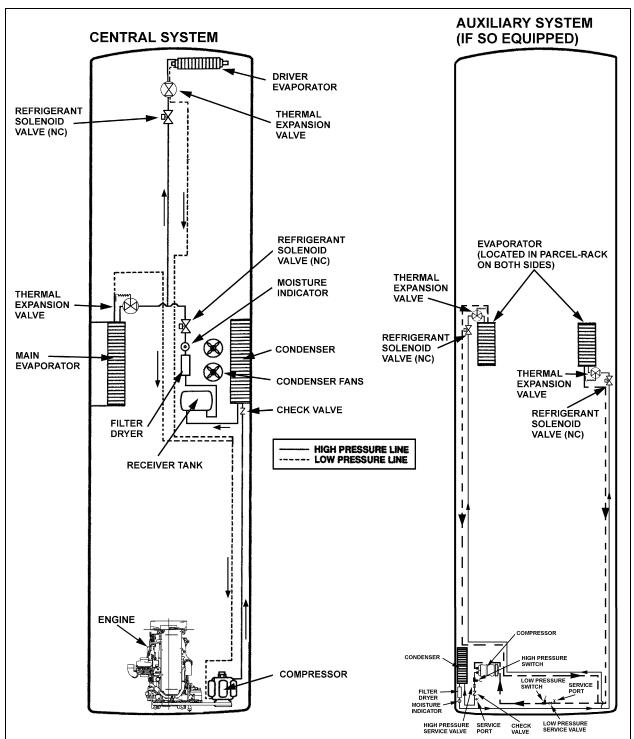
FIGURE 19: REFRIGERANT CIRCUIT (CENTRAL AND AUXILIARY SYSTEMS)
