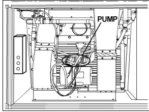
FIGURE 55: PUMP LOCATION (SHELL)
