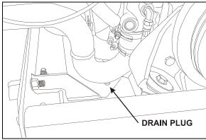
FIGURE 9: WATER PUMP DRAIN PLUG
