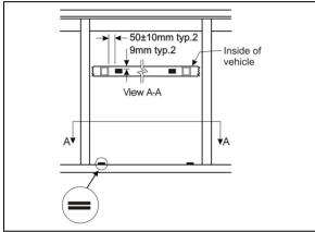
FIGURE 61: AWNING WINDOW - RUBBER BUMPER
