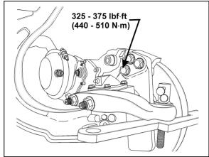
FIGURE 38: TORQUE SPECIFICATION
