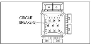
FIGURE 88: VEC CIRCUIT BREAKERS ON SLIDE-OUT CONTROL PANEL
