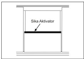
FIGURE 72: SLIDING WINDOW - SIKA AKTIVATOR
