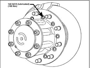
FIGURE 39: TORQUE SPECIFICATION
