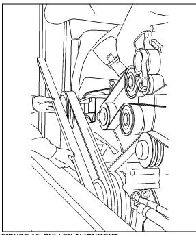
FIGURE 18: PULLEY ALIGNMENT
