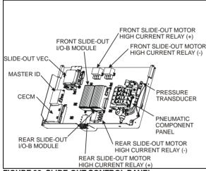
FIGURE 90: SLIDE-OUT CONTROL PANEL
