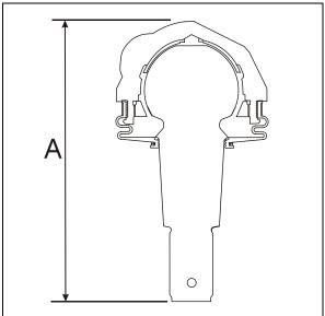
FIGURE 19: UPPER A-ARM CENTRAL BALL JOINT 16116
