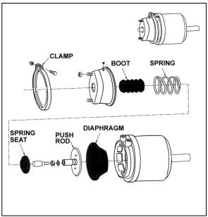
FIGURE 42: TAG AXLE BRAKE AIR CHAMBER
