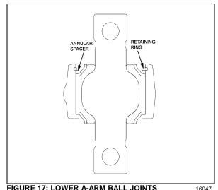
FIGURE 17: LOWER A-ARM BALL JOINTS
