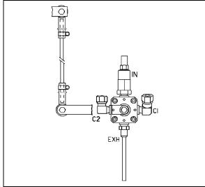
FIGURE 26: FRONT HEIGHT CONTROL VALVE
