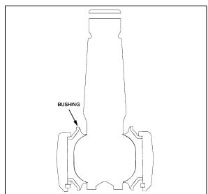
FIGURE 18: LOWER A-ARM CENTRAL BALL JOINT
