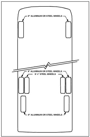
FIGURE 1: ALUM/STEEL WHEEL ARRANGEMENT 13001
