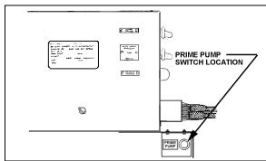
FIGURE 9: PRIME PUMP SWITCH LOCATION
