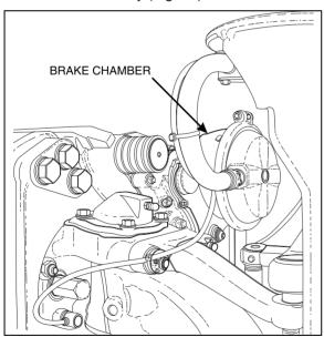
FIGURE 41: FRONT AXLE BRAKE AIR CHAMBER 12158
