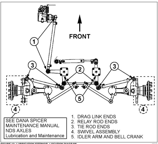
FIGURE 13: LUBRICATION FITTINGS' LOCATION DIAGRAM
