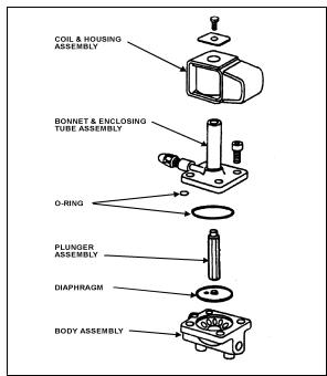
FIGURE 30: REFRIGERANT SOLENOID VALVE
