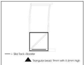
FIGURE 43 : SIDE PANEL INSTALLATION - SIKA TACK+BOOSTER APPLICATION
