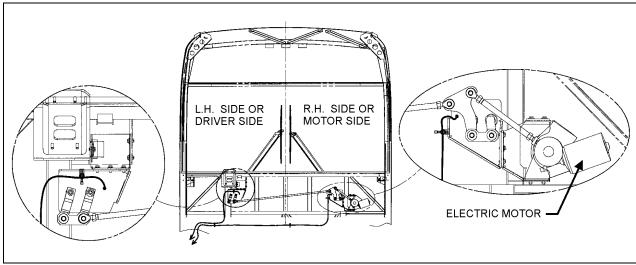
FIGURE 31: WINDSHIELD WIPER INSTALLATION
