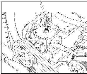
FIGURE 14: FAN GEARBOX
