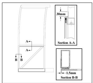
FIGURE 44: SIDE PANEL INSTALLATION
