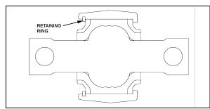
FIGURE 15: UPPER A-ARM BALL JOINTS
