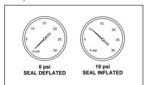
FIGURE 93: INFLATABLE SEAL PRESSURE GAGE
