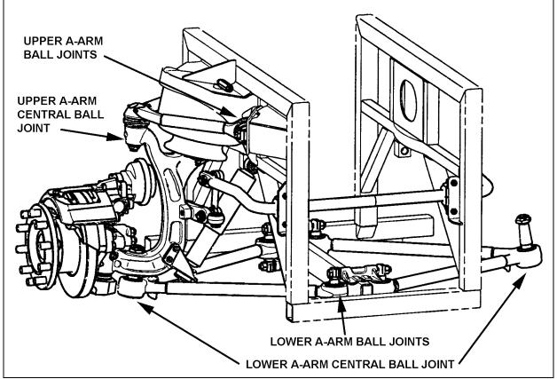
FIGURE 12: BALL JOINTS LOCATION
