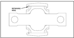
FIGURE 28: UPPER A-ARM BALL JOINTS
