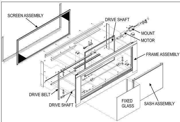
FIGURE 21: ELECTRIC SLIDING WINDOW EXPLODED VIEW
