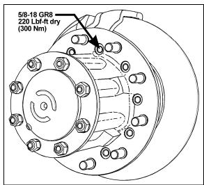
FIGURE 9: TORQUE SPECIFICATION
