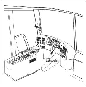
FIGURE 9: DDR CONNECTOR LOCA TION IN DRIVER'S AREA 18558
