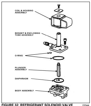
FIGURE 32: REFRIGERANT SOLENOID VALVE
