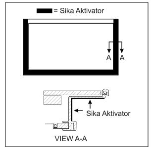
FIGURE 71: SLIDING WINDOW - SIKA AKTIVATOR
