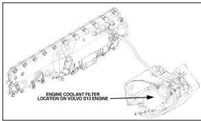
FIGURE 8: COOLANT FILTER (VOLVO D13)
