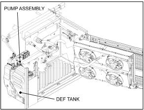
FIGURE 11: DEF TANK AND PUMP LOCATION
