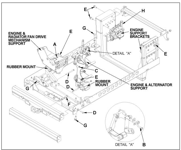
FIGURE 13: VOLVO ENGINE POWER PLANT CRADLE INSTALLATION
