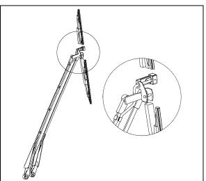
FIGURE 8: WINDSHIELD WIPER (DRIVER SIDE) 23328
