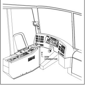
FIGURE 21: DDR CONNECTOR LOCA TION IN DRIVER'S AREA 18558
