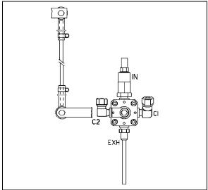
FIGURE 51: FRONT HEIGHT CONTROL VALVE
