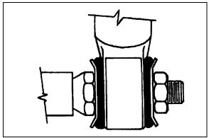
FIGURE 5: TYPICAL SHOCK ABSORBER SETUP 1600
