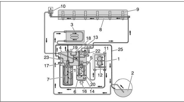
FIGURE 1: FUEL SYSTEM SCHEMATIC (VOLVO D13 ENGINE)
