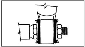
FIGURE 43: TYPICAL SHOCK ABSORBER SETUP 16009
