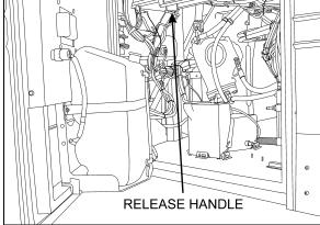
FIGURE 71: FRONT BUMPER RELEASE HANDLE 180
