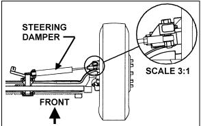
FIGURE 19: STEERING STABILIZER (DAMPER)
