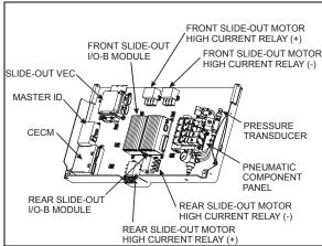
FIGURE 90: SLIDE-OUT CONTROL PANEL
