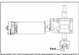
FIGURE 19: CLAMPING HUB POSITION ON GEARBOX SHAFT
