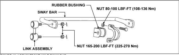
FIGURE 10: I-BEAM FRONT AXLE SWAY BAR
