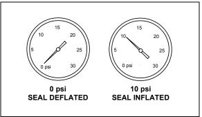
FIGURE 93: INFLATABLE SEAL PRESSURE GAGE
