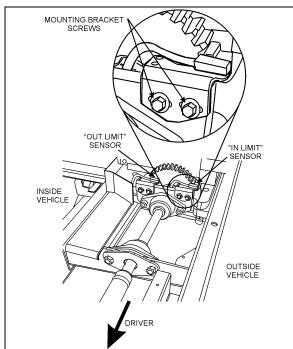
FIGURE 37: FRONT SLIDE-OUT SENSORS
