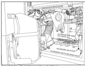
FIGURE 56: FRONT VALVE LOCATION
