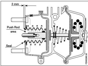
FIGURE 30: DRIVE AXLE BRAKE AIR CHAMBER
