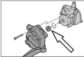
FIGURE 7: FUEL PUMP DRIVE AXLE
