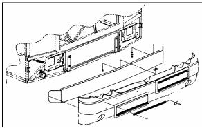
FIGURE 72: FRONT BUMPER REMOVAL
