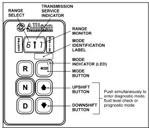
FIGURE 2: ALLISON TRANSMISSION CONTROL PAD 07142
