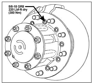
FIGURE 28: TORQUE SPECIFICATION
