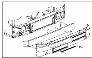
FIGURE 49: FRONT BUMPER REMOVAL
