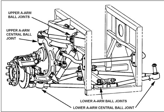
FIGURE 25: BALL JOINTS LOCATION
