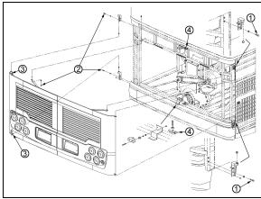
FIGURE 79: ENGINE COMPARTMENT DOORS
