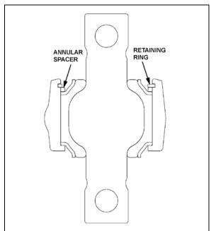
FIGURE 27: LOWER A-ARM BALL JOINTS
