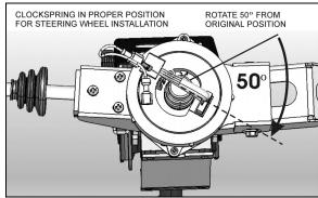
FIGURE 13: PROPER CLOCKSPRING POSITION
