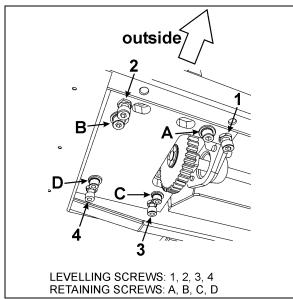
**FIGURE 22 : SLIDE-OUT LEVELING**
