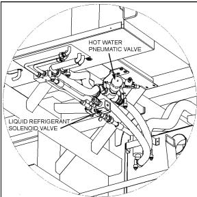
FIGURE 31: DRIVER'S EVAPORATOR LIQUID SOLENOID VALVE 22324
