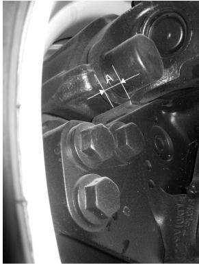
FIGURE 25: BRAKE PAD WEAR INSPECTION
