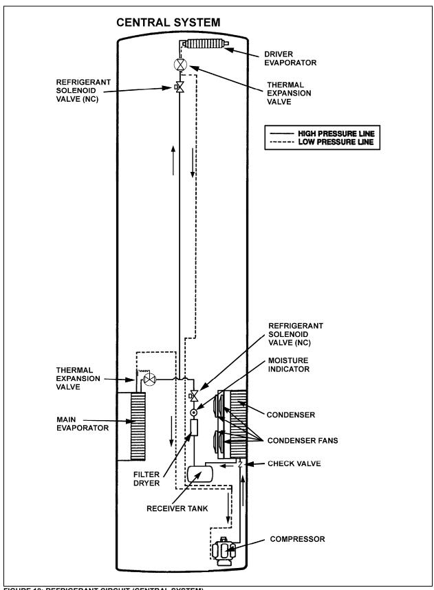
FIGURE 18: REFRIGERANT CIRCUIT (CENTRAL SYSTEM)
