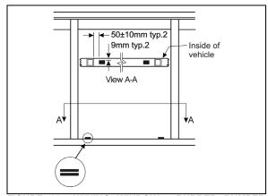
FIGURE 61: AWNING WINDOW - RUBBER BUMPER INSTALLATION
