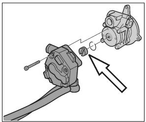
FIGURE 5: FUEL PUMP DRIVE AXLE
