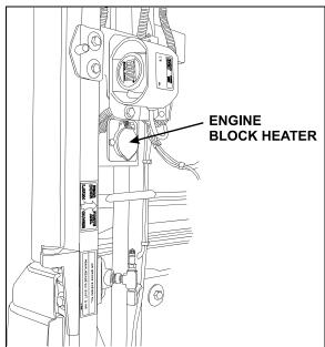
FIGURE 47: ELECTRIC HEATER PLUG LOCATION 18354
