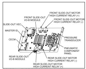
FIGURE 35 : SLIDE-OUT CONTROL PANEL
