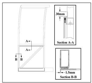
FIGURE 44: SIDE PANEL INSTALLATION
