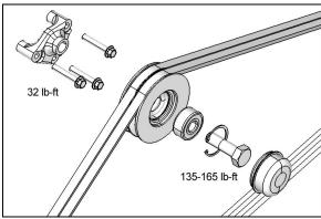
FIGURE 22: IDLER PULLEY INSTALLATION ON VOLVO D13 ENGINE
