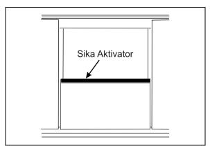
FIGURE 72: SLIDING WINDOW - SIKA AKTIVATOR
