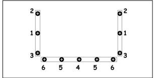
FIGURE 74: CORRECT TIGHTENING SEQUENCE
