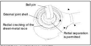
FIGURE 26: A-ARM BALL JOINTS
