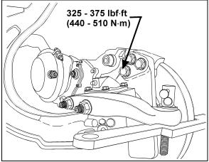
FIGURE 27: TORQUE SPECIFICATION
