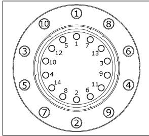
FIGURE 2: TIGHTENING SEQUENCE
