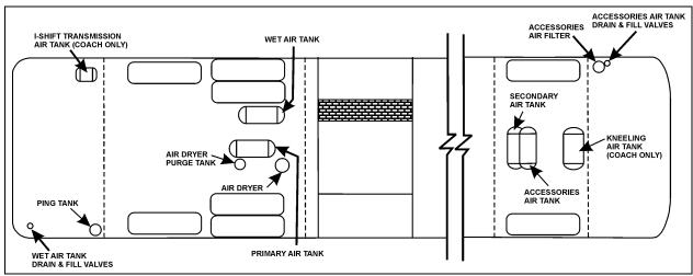
FIGURE 54: I-BEAM FRONT SUSPENSION AIR TANKS LOCATION
