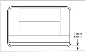
FIGURE 21: SLIDE-OUT LEVEL ADJUSTEMENT
