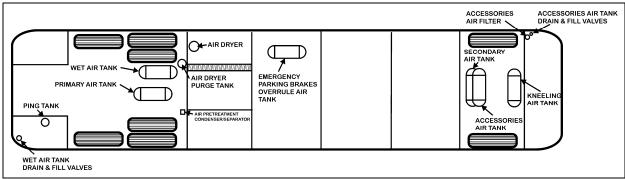
FIGURE 1: I-BEAM FRONT SUSPENSION AIR RESERVOIRS LOCATION
