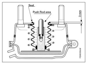
FIGURE 29: FRONT AXLE BRAKE AIR CHAMBER 121
