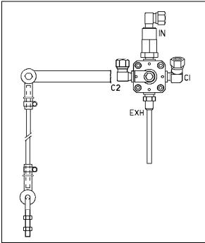
FIGURE 52: REAR HEIGHT CONTROL VALVE
