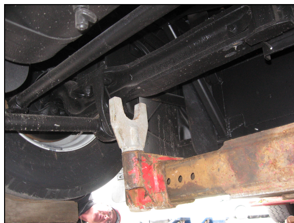
LEVAGE PAR L'ESSIEU AVANT
