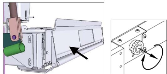
2. Lever la tige du détenteur de pression jusqu'à ce que la plate-forme commence à s'abaisser (l'ouverture de la valve fait descendre la plate-forme).
