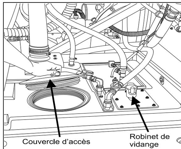
RÉSERVOIR D'EAU USÉE – RÉSERVOIR UNIQUE 23294
