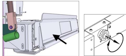
4. Appuyer sur le bouton à la base de la main courante gauche puis soulever la main courante hors de son réceptacle. Rabattre la main courante sur la plate-forme. Répéter pour la main courante droite.
