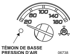
Jauge de pression d'air du circuit de freinage des essieux arrière
