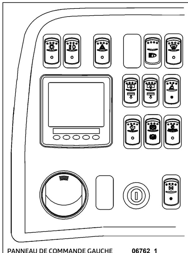
Le panneau de commande gauche du tableau de bord comprend les interrupteurs de commande pour la conduite de l'autocar. Il comprend également le commutateur d'allumage et un registre d'air réglable pour le conducteur.
