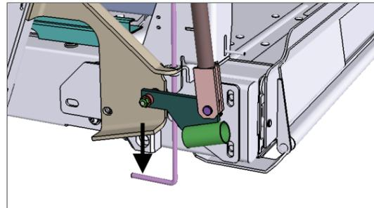
**Pour rétracter la plate-forme de façon manuelle**
