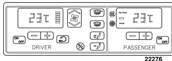
L'intérieur de l'autocar est pressurisé par le système de chauffage et de climatisation. Le débit d'air et les commandes divisent l'intérieur de l'autocar en deux zones, soit :
