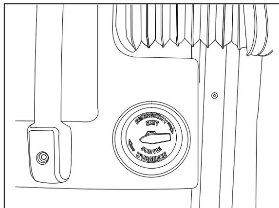
Une soupape d'ouverture d'urgence située sur la console de droite, à gauche des marches en sortant de l'autocar permet l'ouverture d'urgence de la porte d'entrée. Une autre soupape d'ouverture d'urgence est située dans le compartiment électrique et de service avant et permet d'ouvrir la porte de l'extérieur.
