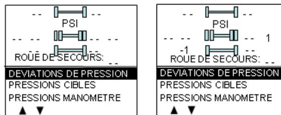
Tel qu'illustré, les lectures de pression apparaissent en remplacement des tirets à mesure que l'afficheur du TPMS reçoit les données du récepteur du TPMS. Cela peut prendre 1 minute avant que toutes les lectures
