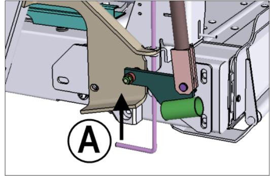
4. Tirer sur le bouton rotatif de la rampe et tourner dans le sens contraire des aiguilles d'une montre. La rampe doit reposer bien à plat sur le sol.
