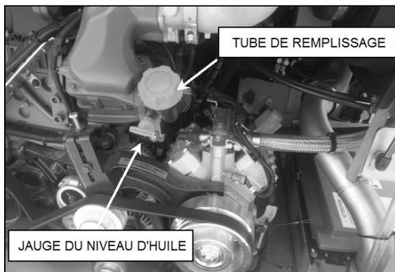
JAUGE ET TUBE DE REMPLISSAGE DU MOTEUR 01192\_3
