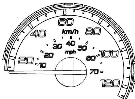
Indique la vitesse de l'autocar en kilomètres à l'heure (km/h) et en milles à l'heure (mi/h). Les diodes électroluminescentes situées au-dessus de l'indicateur fonctionnent de pair avec le régulateur de vitesse et d'espacement avec freinage disponible en option. Voir le paragraphe « Régulateur de vitesse et d'espacement avec freinage » pour plus d'information à ce sujet.
