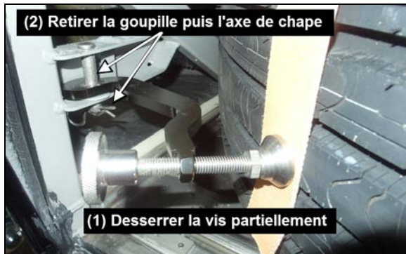
RETRAIT DE LA ROUE DE SECOURS 13038
