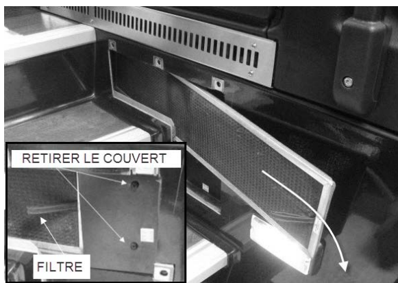
RETRAIT DU FILTRE SECTION CONDUCTEUR
