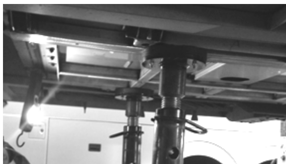
FIGURE 21: CHANDELLES SOUS LE SUPPORT DU RÉSERVOIR DE CARBURANT
