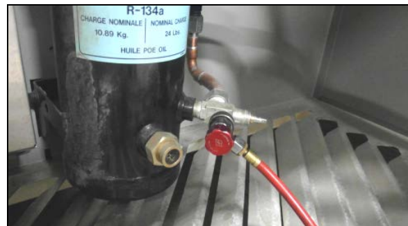
FIGURE 83 : UNITÉ DE RÉCUPÉRATION CONNECTÉE AU RACCORD DE SERVICE DU RÉSERVOIR DE STOCKAGE
