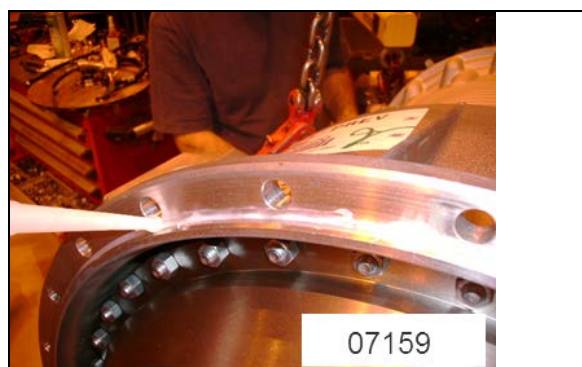
FIGURE 12: APPLICATION DE SILICONE AU CARTER DE BOÎTE DE VITESSES
