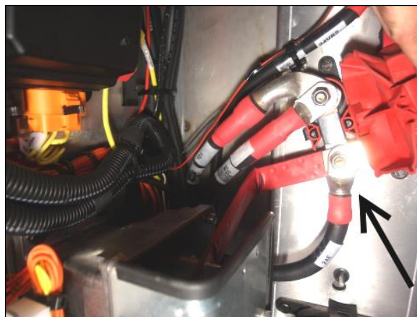
Figure 3: Bloc de jonction Bussman - Série H3
