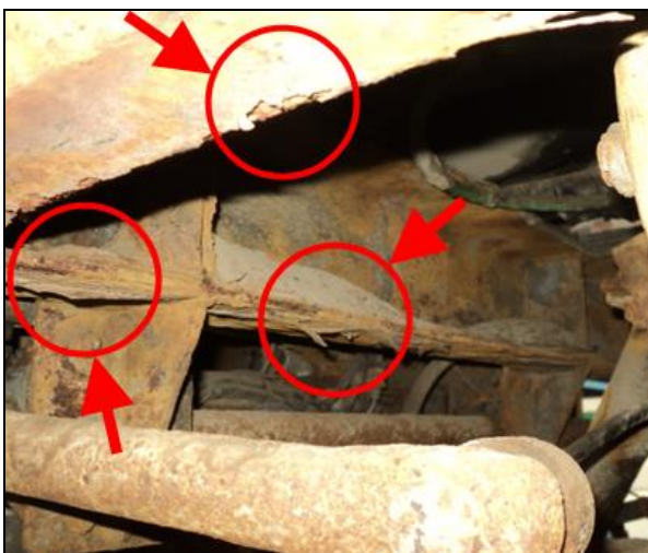
FIGURE 3: ÉCAILLAGE DU MÉTAL ET ACCUMULATION DE SABLE
