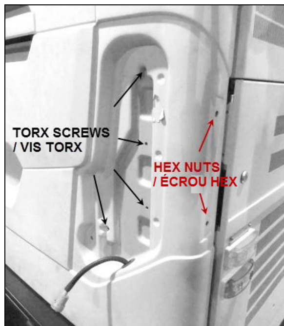
FIGURE 87 : VIS DE FIXATION ET ÉCROUS DU MODULE DES FEUX ARRIÈRE
