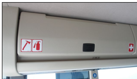
LA PRÉSENCE D'AUTOCOLLANTS INDIQUE QU'UNE HACHE D'INCENDIE, UN EXTINCTEUR ET UNE TROUSSE DE PREMIERS SOINS SONT RANGÉS DANS CE PORTE-BAGAGE À MAIN
